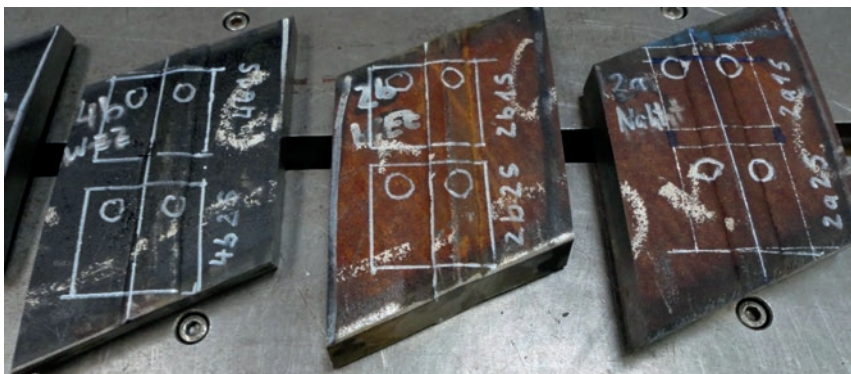
Abb. 2b: Probenentnahme aus einem Rohr
