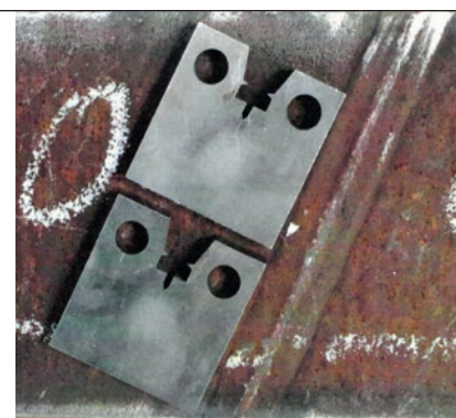
Abb. 2 a (links): Probengeometrie für Bruchmechanikprüfungen-Versuche
