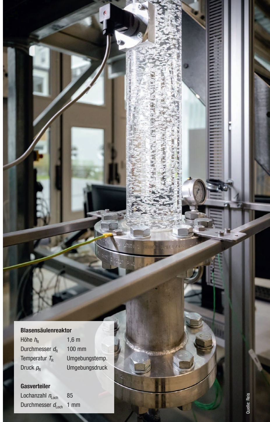
Abb. 2: Versuchsstand zur Untersuchung der Hydrodynamik in Blasenströmungen mit einer optischen Nadelsonde. In der Bildlegende sind die technischen Daten der Blasensäule angegeben.
