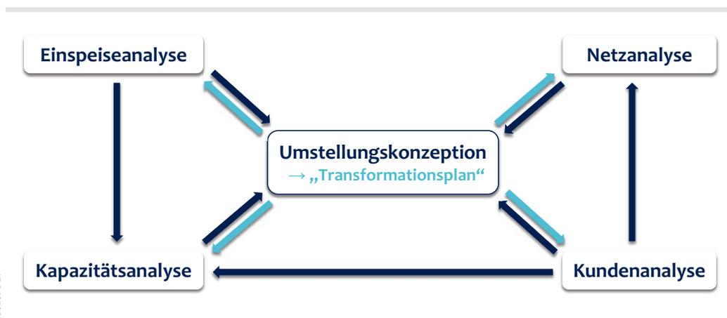
Abb. 2: Schema der Transformationsplanung zur Umstellung eines Netzgebietes auf Wasserstoff
