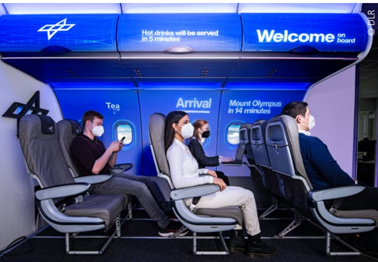
Im DLR-Institut für Systemarchitekturen in der Luftfahrt werden mittels Projektionsverfahren oder Extended-Reality-Anwendungen neue Kabinenkonzepte getestet.
