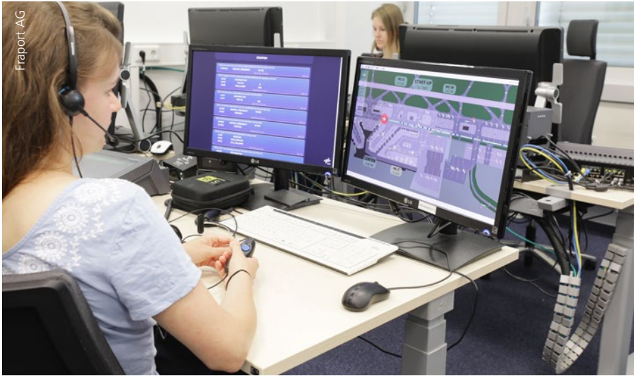
Für den Versuch wurden die Pilotinnen und Piloten mehrerer Flugzeuge simuliert. Hier steuert eine Person zehn Flugzeuge gleichzeitig als „Pilotin“.
