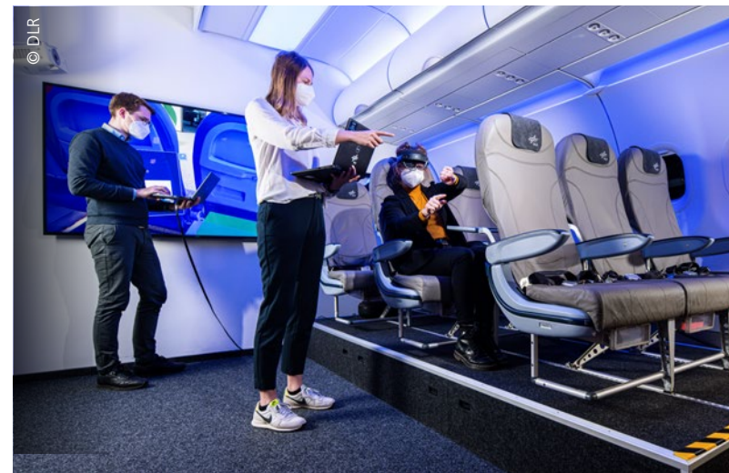
Im DLR-Institut für Systemarchitekturen in der Luftfahrt werden mittels Projektionsverfahren oder Extended-Reality-Anwendungen neue Kabinenkonzepte getestet.
