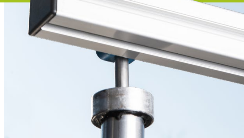
Über diesen Messkopf wird die Luft angesaugt und von Teilchen gereinigt, die zu groß sind.
