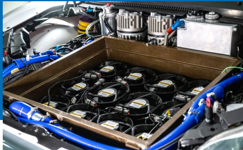
Der Blick unter die Haube zeigt die unterstützenden Lüfter der Reifenpartikelabsaugung.
