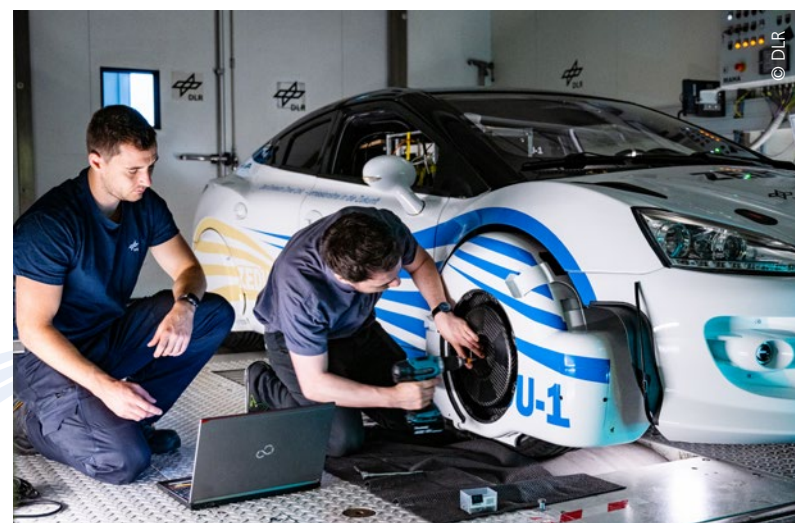
Fabius Epple und Sven Reiland vom DLR-Institut für Fahrzeugkonzepte, beide Mitglieder des ZEDU-Teams, montieren die Verkleidung auf das Messrad.
