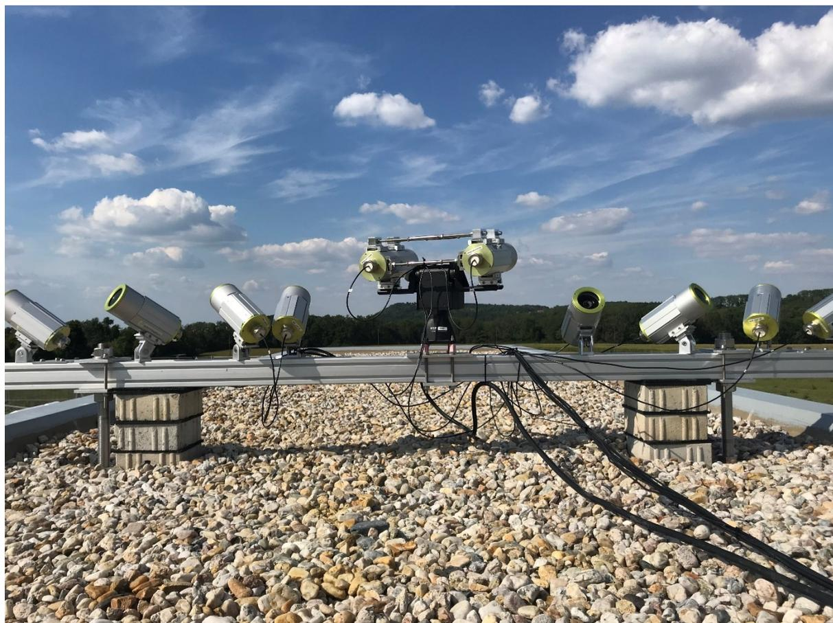
Abb. 6: Testinstallation des BirdRecorders auf dem WINSSENT Windenergiefeld in Stötten bei Geislingen auf der Schwäbischen Alb [Bild ZSW].
