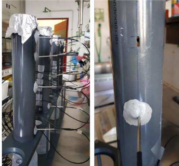
Abb. 6: Aufbau im Experiment zum Sauerstoff-Tiefenprofil des Bodens. Die Sauerstoffsensoren wurden seitlich in die Säulen eingebaut und luftdicht versiegelt.
