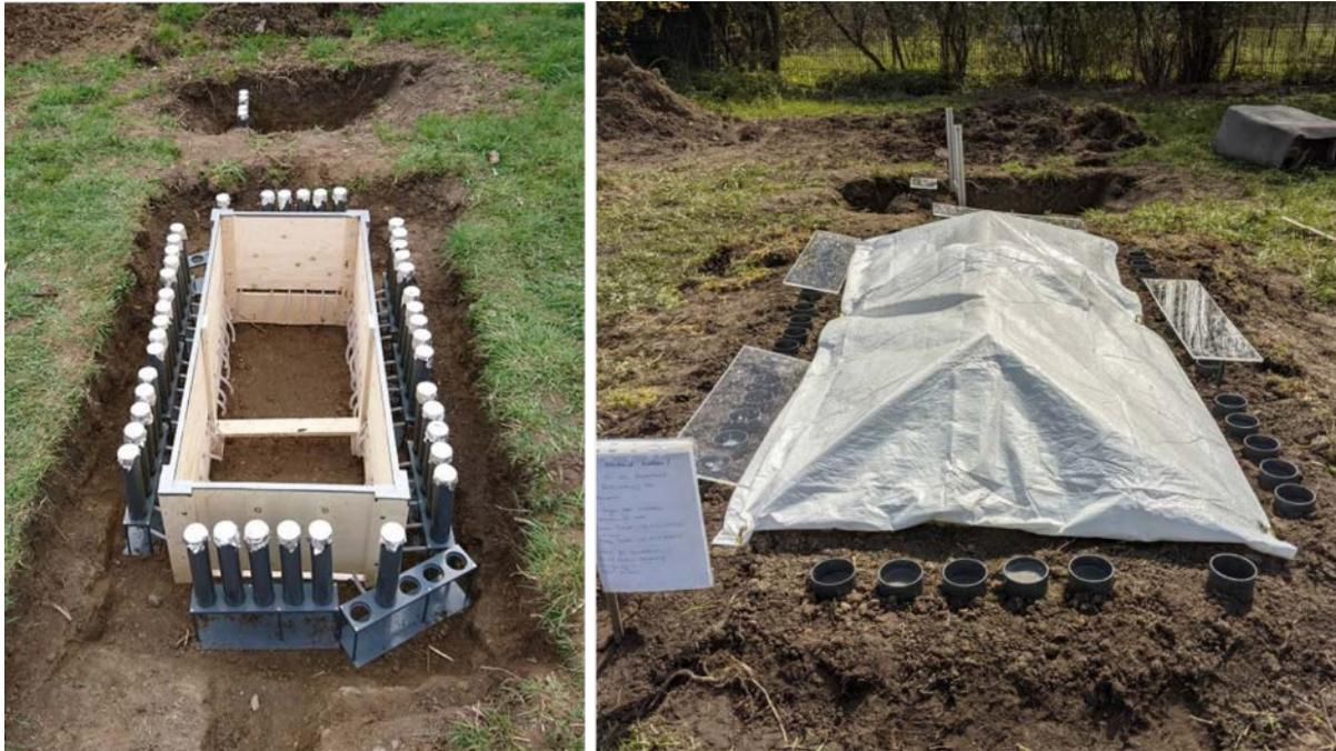
Abb. 9: Einbringen der Bodensäulen in den Wiesenboden für das Semi-Feldexperiment.
