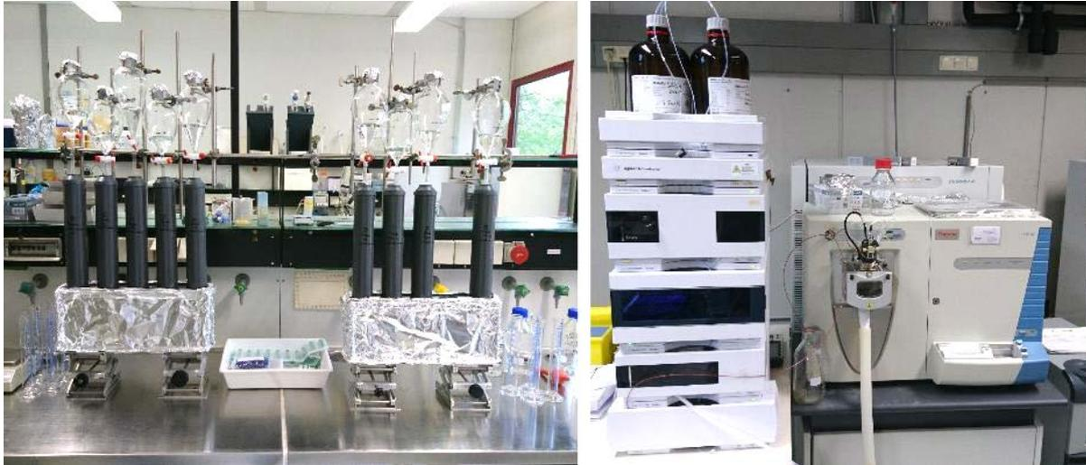
Abb. 7: Aufbau zur Beregnung der Bodensäulen nach Applikation der Pestizide und LC-MS/MS.
