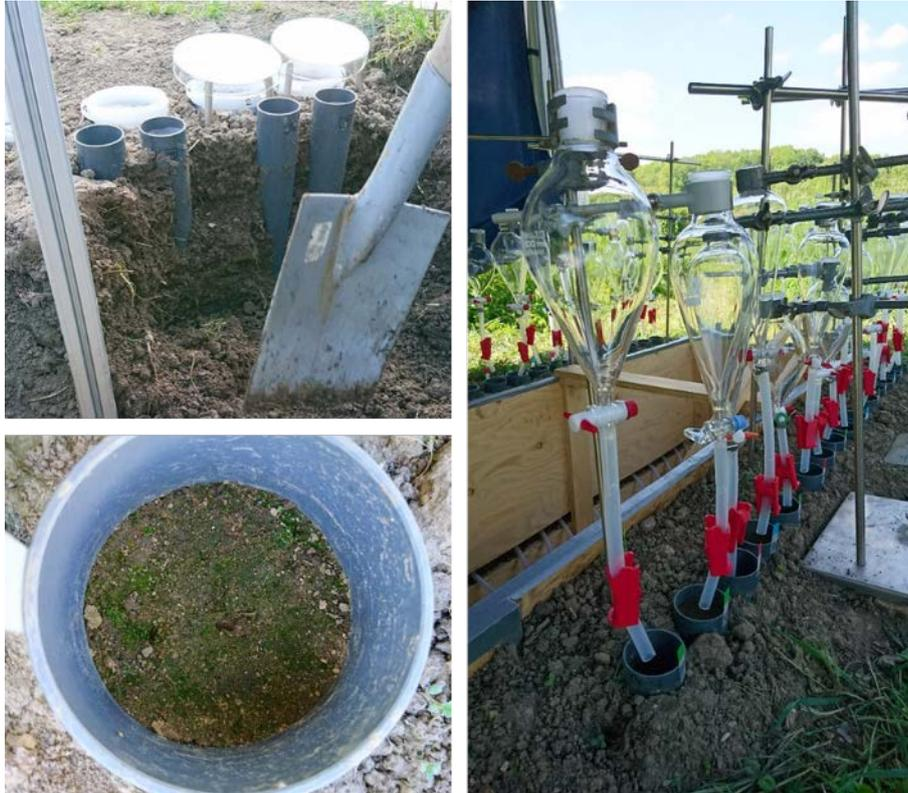
Abb. 10: Oben links: Ausgraben der Referenzbodensäulen zur Bestimmung des Wasserverlusts durch Wiegen. Unten links: Wachstum von Algen und Moos auf der Bodenoberfläche von Bodensäulen im Semi-Feldexperiment. Rechts: Aufbau zur Bewässerung der Bodensäulen im Semi-Feldexperiment.
