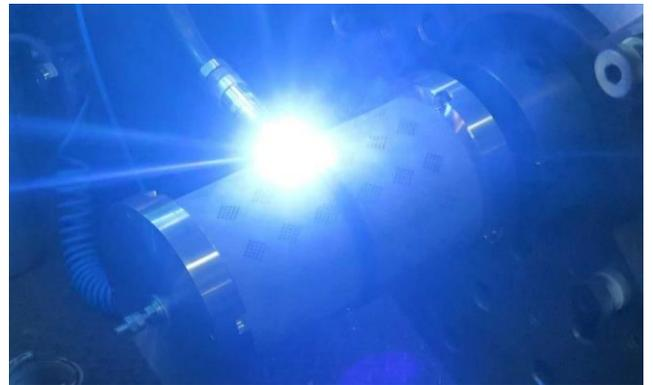
*MSG-Schweißprozess am Walzen-Mantel. (MSG-Welding process at the roller shell.)*
