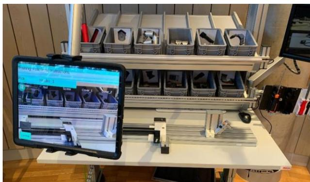
AR eingesetzt bei der manuellen Montage. (AR used for manual assembly.)
