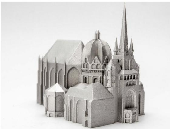
*Aachener Dom gefertigt mittels additiver Verfahren.*
