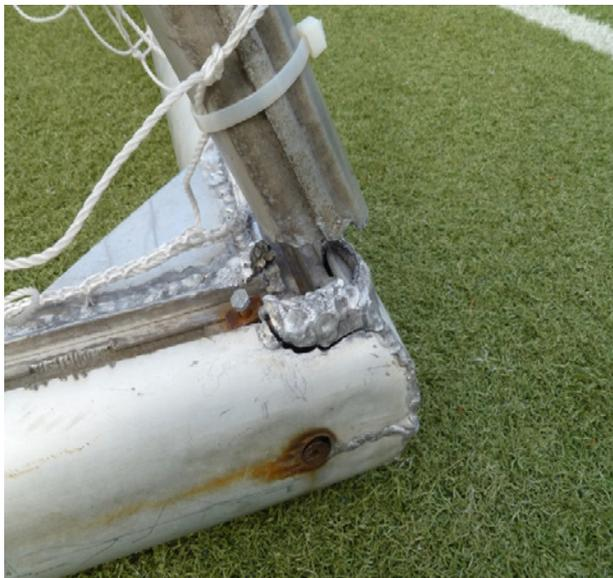
*Nachgeschweißte Verbindungsstelle der hinteren Strebe mit dem Bodenrahmen, die bei einer späteren Nutzung wiederum neben der Schweißnaht gerissen ist.*
