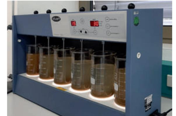
**Flockungsversuche im Labormaßstab in einem Jar-Tester für eine Flockungsanalyse.**
