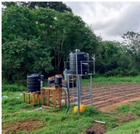
**Versuchsanlage einer Wasser-Aufbereitungsanlage und angeschlossener Tröpfchenbewässerung in Accra.**
