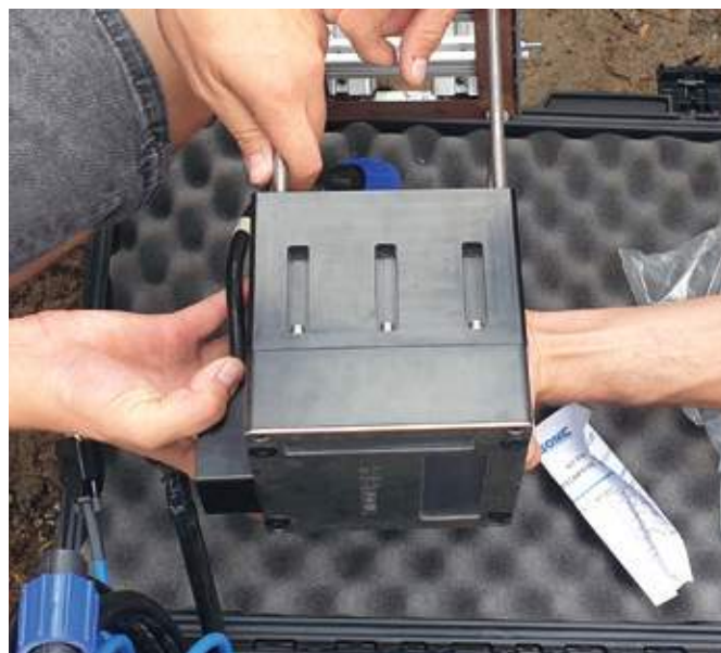
FiW Mitarbeiter Philipp Knollmann mit dem UAV/USV-Tandemsystem am Rursee (links). Montage des Fächerecholots Sonic 2020 und der Halterung für den Test am Rursee (rechts).
