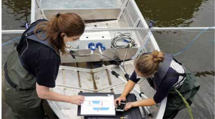
bestätigt. Zum einen wurden mit einer konventionellen Tiefensonde händisch Ergebnisse an der tiefsten Stelle der Talsperre aufgezeichnet. Zum anderen kam das aus dem Projekt RiverView® bekannte RiverBoat zum Einsatz, welches mit seinem Windensystem auf einem Trailer in der Lage war, direkt an dem Turm und somit in nächster Nähe zur tatsächlichen Position des neuen Messsystems Vergleichswerte aufzunehmen.
