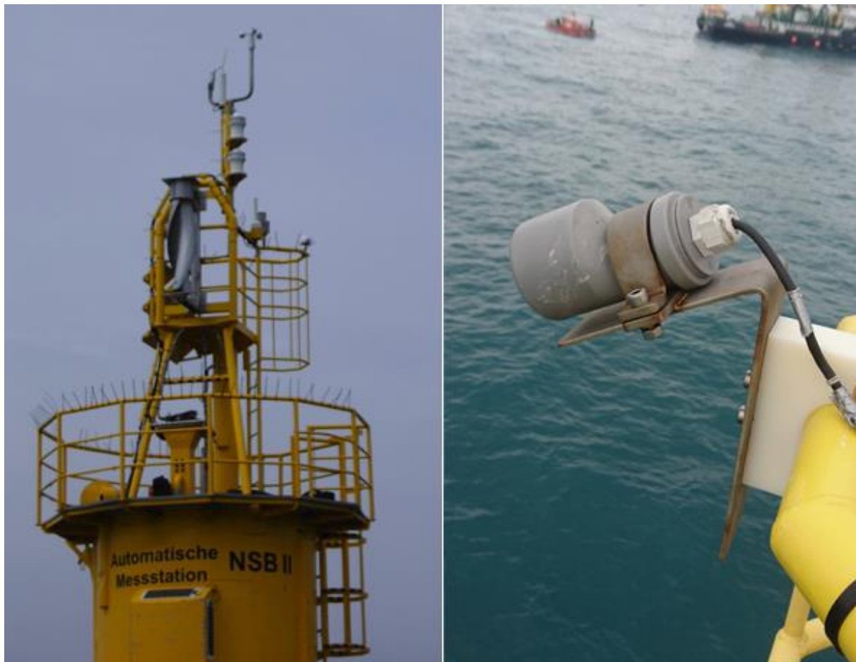
Abbildung 3-6: Erfassungssystem an der Nordseeboje II (Fotos: BSH)
