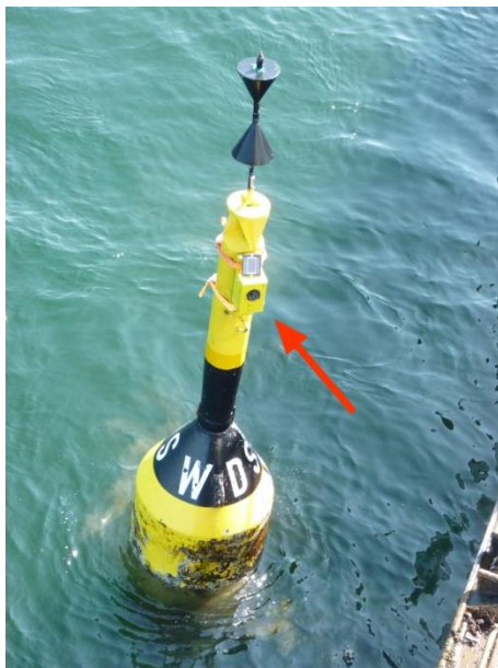
Abbildung 3-15: Tonne DS-W mit Erfassungssystem (Foto: Kapitän Nowak)
