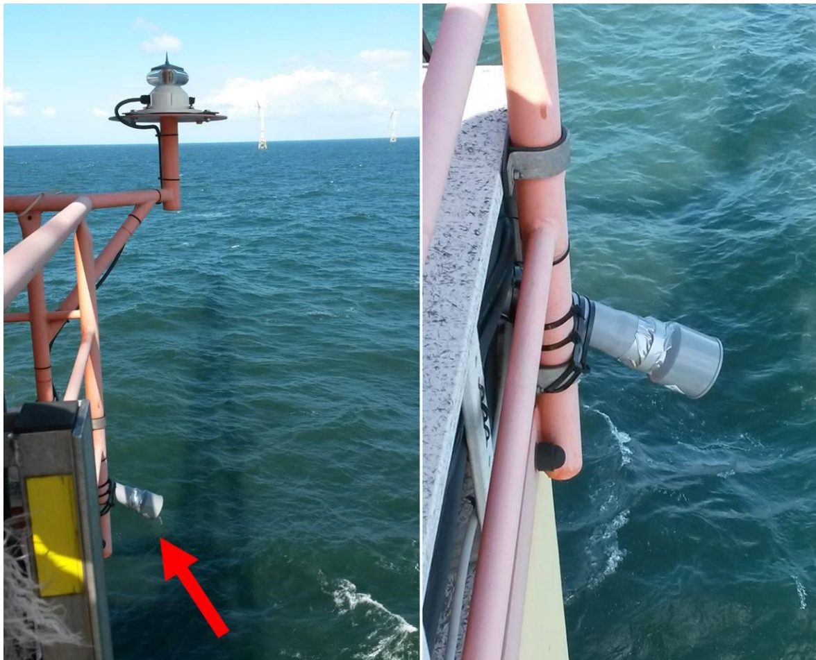
Abbildung 3-8: Mikrofon „Südost“ auf FINO 1 (Fotos: Reinhold Hill).
