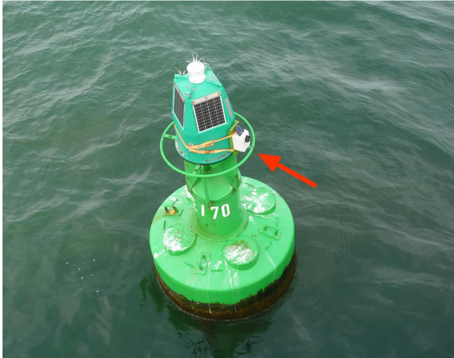
Abbildung 3-14: Tonne E70 mit Erfassungssystem (Foto: Kapitän Nowak)
