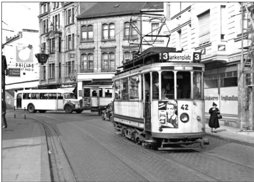
Wagen 42 stand am 27. August 1953 in der Sternstraße vor der mit einer sogenannten Heuer-Ampel gesicherten Kreuzung mit der Meckenheimer Straße. Nach Fahrtfreigabe setzte er seine Fahrt in die Bornheimer Straße fort, die Strecke dort wurde hinter der Kreuzung eingleisig.
