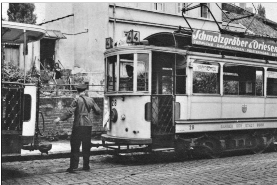
Im Sommer 1951 hat Triebwagen 28 seinen Beiwagen 106 umfahren und wird sich vor ihn setzen. Der Schaffner - in einer der Jahreszeit entsprechenden Uniformjacke - unterstützt den Wagenführer beim Kuppelvorgang.
