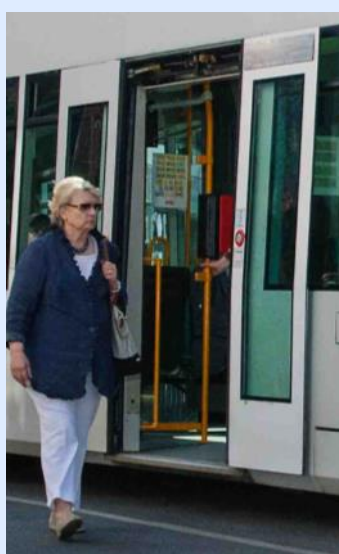
Rechts: Seit 1994 ist es nur noch ein Schritt von 35 Zentimeter Höhe (SWB-Niederflurwagen 9453).
