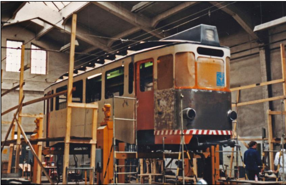
Umbau des Arbeits- triebswagens A32 zur Partybahn. Ohne sein dreiach- siges Lenkgestell steht er im Mai 1987 auf der Ar- beitsplattform im Betriebshof Fries- dorf. Die Scheinwerfer wurden schon dem Anlieferungszu- stand angepasst.
