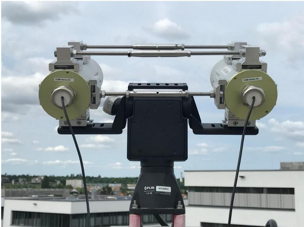
Abb. 19: Stereokamera paar auf dem Schwenkneigekopf.
