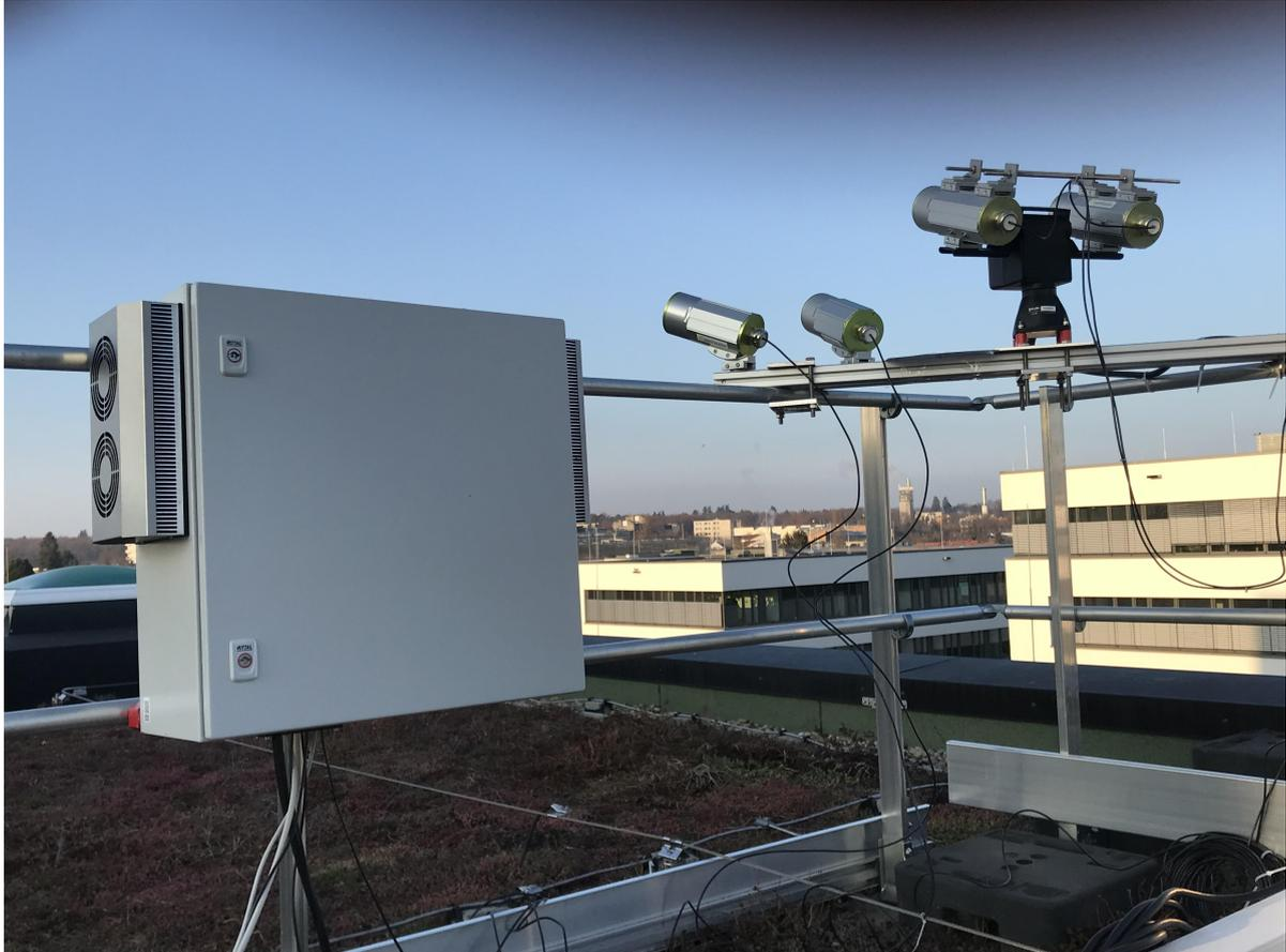
Abb. 3: Testinstallation des BirdRecorder Systems IPC-2 auf dem Dach des ZSW in Stuttgart mit klimatisiertem Schaltschrank, statisch montierten Kameras sowie Schwenkneigekopf mit Stereokamera paar.
