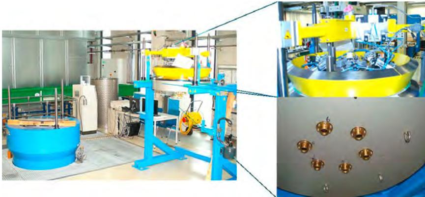
Abb. 2: Drucktank des Lehrstuhls für Meerestechnik der Universität Rostock – links der Öffnungsbereich des in den Boden versenkten Tanks, rechts der Deckel mit Halterung.
