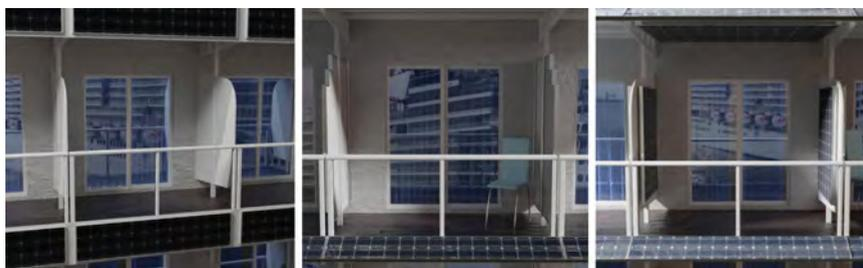
Abb. 13: Designstudien von Photovoltaikanlagen, die am Balkon einer Außenkabine installiert sind. Links: Ein planar installiertes Modul, Mitte: Ein geneigtes Modul, Rechts: Ein geneigtes Modul, zwei an den Trennwänden installierte Module, ein unter der Decke installiertes Modul zur Ausnutzung der reflektierten Strahlung.
