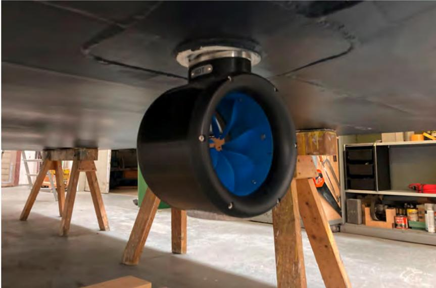
Abb. 6: schwenkbarer RIM-DRIVE
