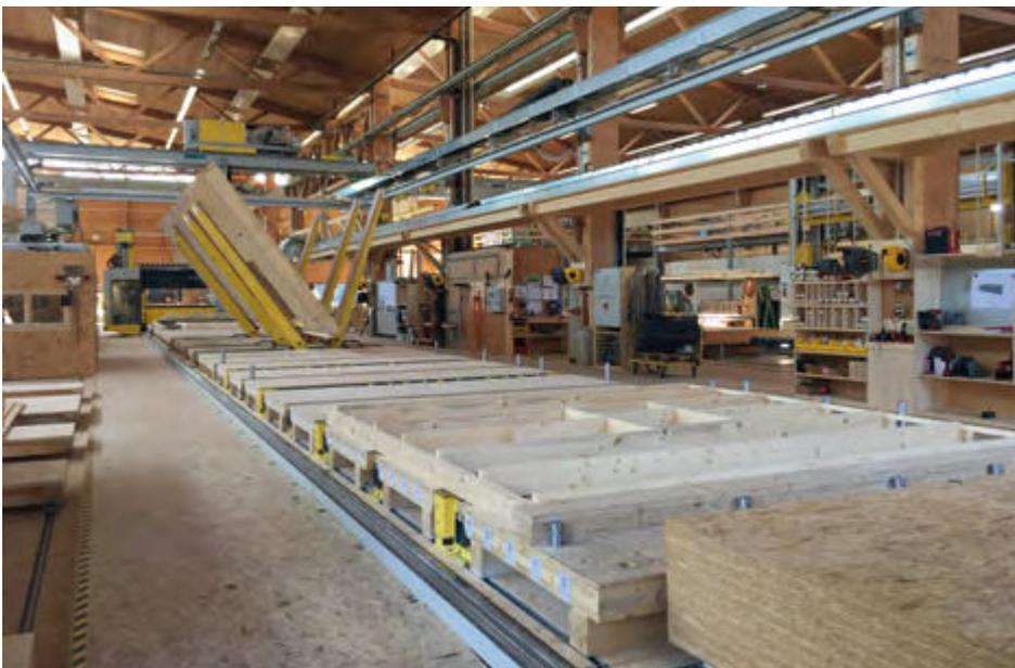
Bild 1: moderne Fertigungslinie bei Gump & Maier, Binswangen
