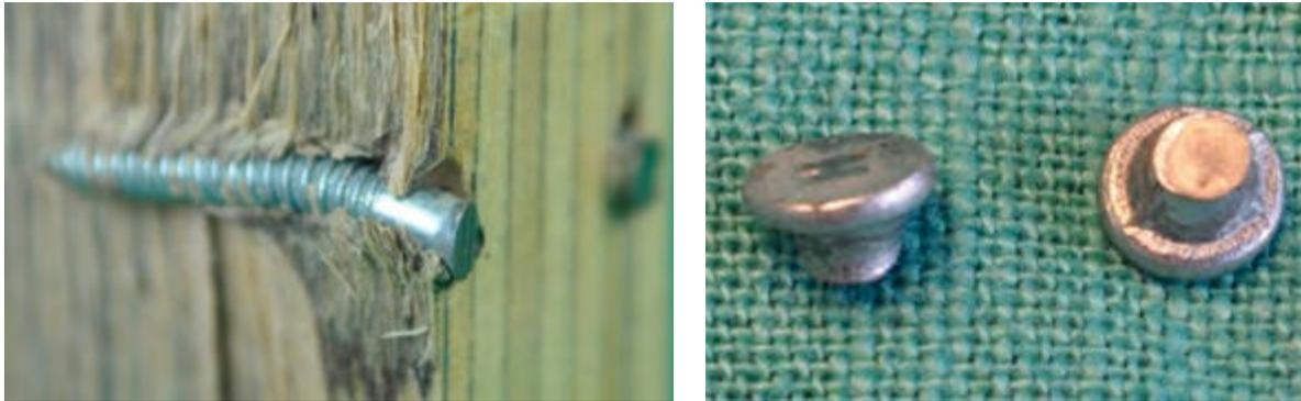
**Bild 8:** Nagelscherversagen in Stahlblech-Holz-Verbindungen mit Rillennägeln in Furnierschichtholz aus Buche (links) und abgescherte Nagelköpfe (rechts)
