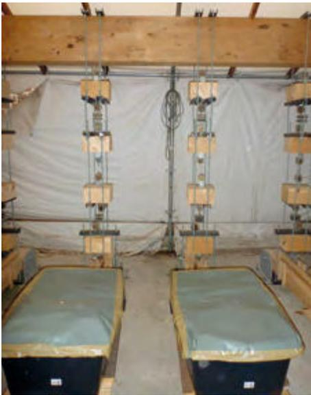
**Bild 10 (links):** Testaufbau für die Kriechbelastungsversuche der Schrauben im Zelt unter Außenklima.
