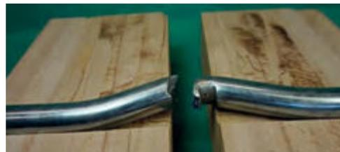
Bild 2 (rechts): Kombiniertes Biege- und Scherversagen eines Stabdübels in einer Verbindung mit innen liegendem Stahlblech und Seitenhölzern aus Buchenbrettschichtholz
