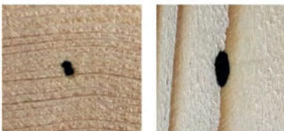
**Bild 16 (links):** Verzerrte Bohrlochformen einer faserparallelen und einer rechtwinklig eingebrachten Laserbohrung infolge Materialanisotropie, unten: Bohrlochsnitte: Die Zellstruktur bildet sich im Bohrlochquerschnitt infolge Dichteunterschiede ab.
