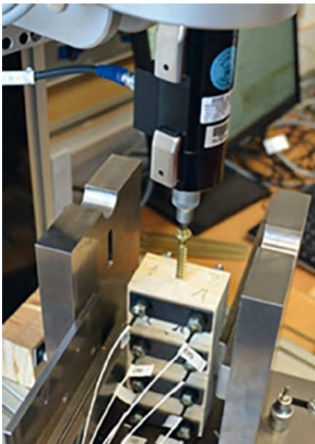
Bild 1: Versuchseinrichtung zur Ermittlung von Einschraub-Spaltkräften an der FH Aachen
