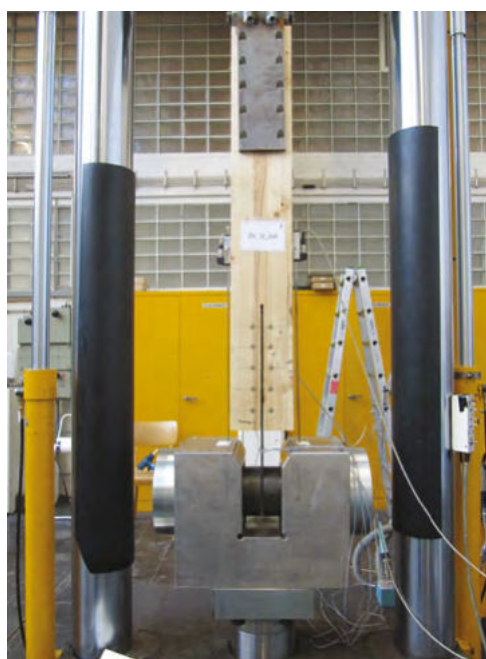
Bild 4: Zugversuche mit Stabdübeln des Ø 12 mm (a) Versuchsaufbau (b) Versuchsergebnisse
