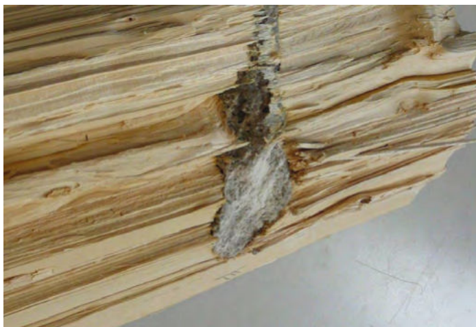
Bild 5: Scherfläche der Vergussäule im Versuch
