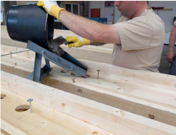
Bild 7: Herstellung der Drucksäulen im Werk
