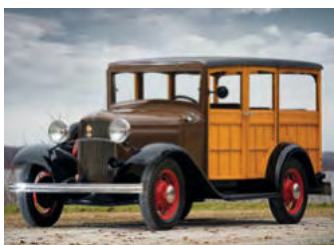
Bild 1: Hölzerner Karosseriebau > 1932 Ford Model B Station Wagon > 1936 DKW F5 Front Luxus Sport > 1938 Opel-Blitz Auwärter-Aufbau Quellen (von links nach rechts): i.wheelsage.org, www.holzkarosserie.de www.konrad-auwaerter.de
