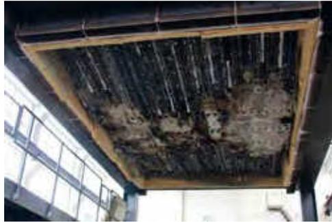
**Bild 4:** Abbrand am Versuchskörper
