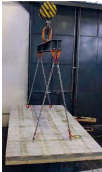
**Bild 2:** Ein Prüfkörper ausbetoniert beim Einbau in den Ofen
