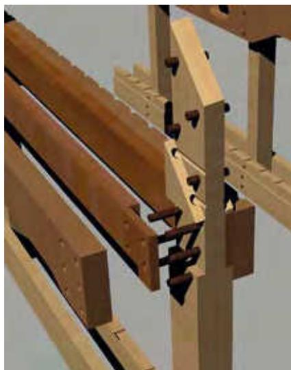
**Bild 8:** Entwurf eines Knotens ganz in Holz
