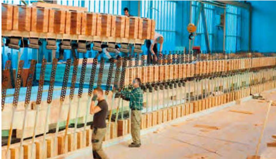
**Bild 12: Blockverklebung der Einzelquerschnitte**
