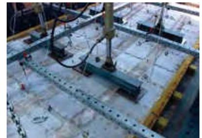
**Bild 3:** Anordnung Belastung auf der Decke
