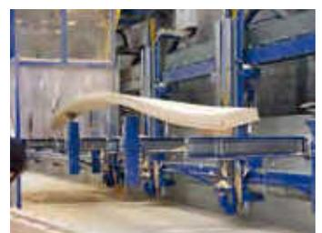
Bild 13: Bearbeitung eines geschwungen Balkens mit einer 5-achs-CNC-Anlage
