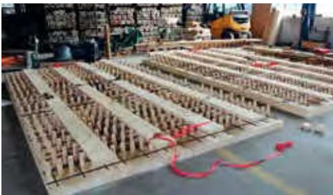
**Bild 1:** Die beiden Prüfkörper vor dem Verguss mit Beton: Holzstärke links 80 mm, rechts 120 mm, Beton füllend auf 240 mm
