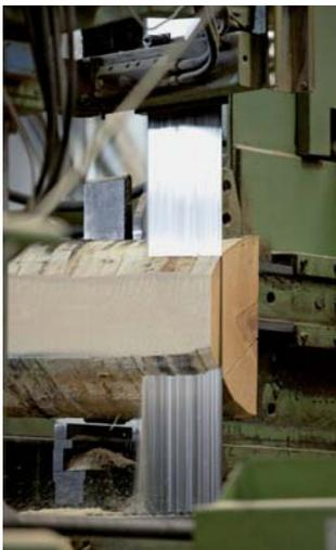
**Bild 4: Bearbeitung von Buchenholz mittels Bandsäge**
