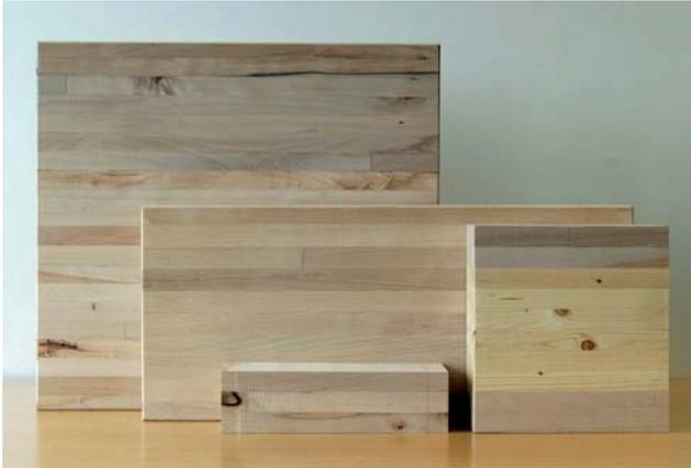
**Bild 5: Brettschichtholz aus Buche bzw. mit hybridem Aufbau**
