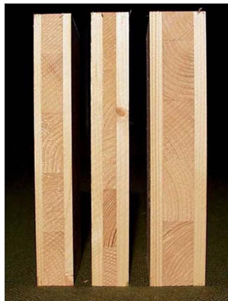
**Bild 2:** Unterschiedliche Ausbildung von Brettstößen und Anordnung von Entlastungsnuten
