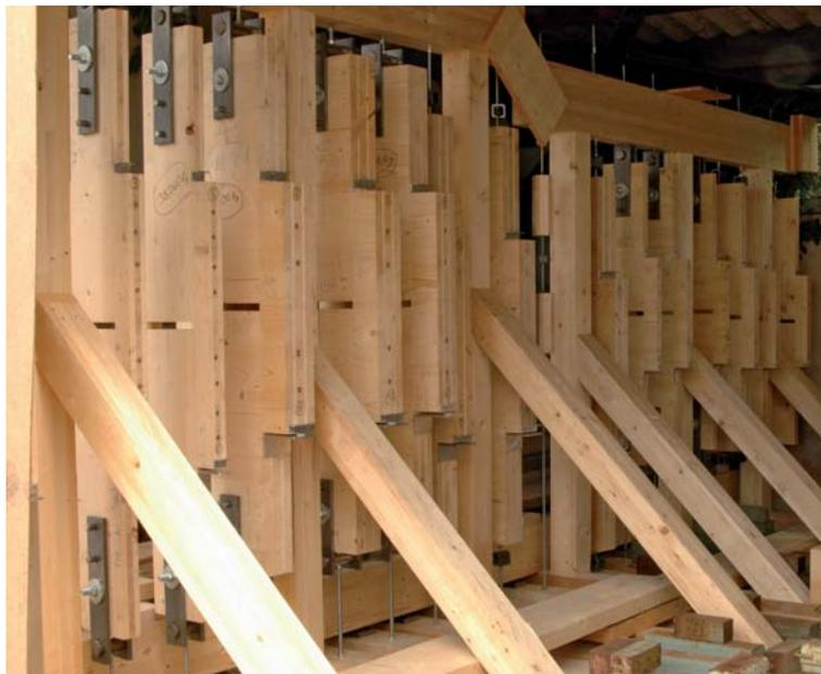
**Bild 16: Langzeitversuche mit auf Herausziehen und mit auf Abscheren beanspruchten selbstbohrenden Holzschrauben**
