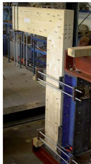
Bild 4: Versuchsaufbau biegesteife Rahmenecke mit negativem Moment im Projekt "MSB 2"
