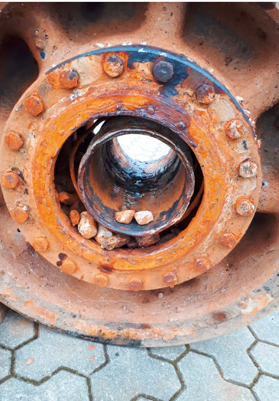
Laufрад des Unterwagens mit zerstörtem Lager
