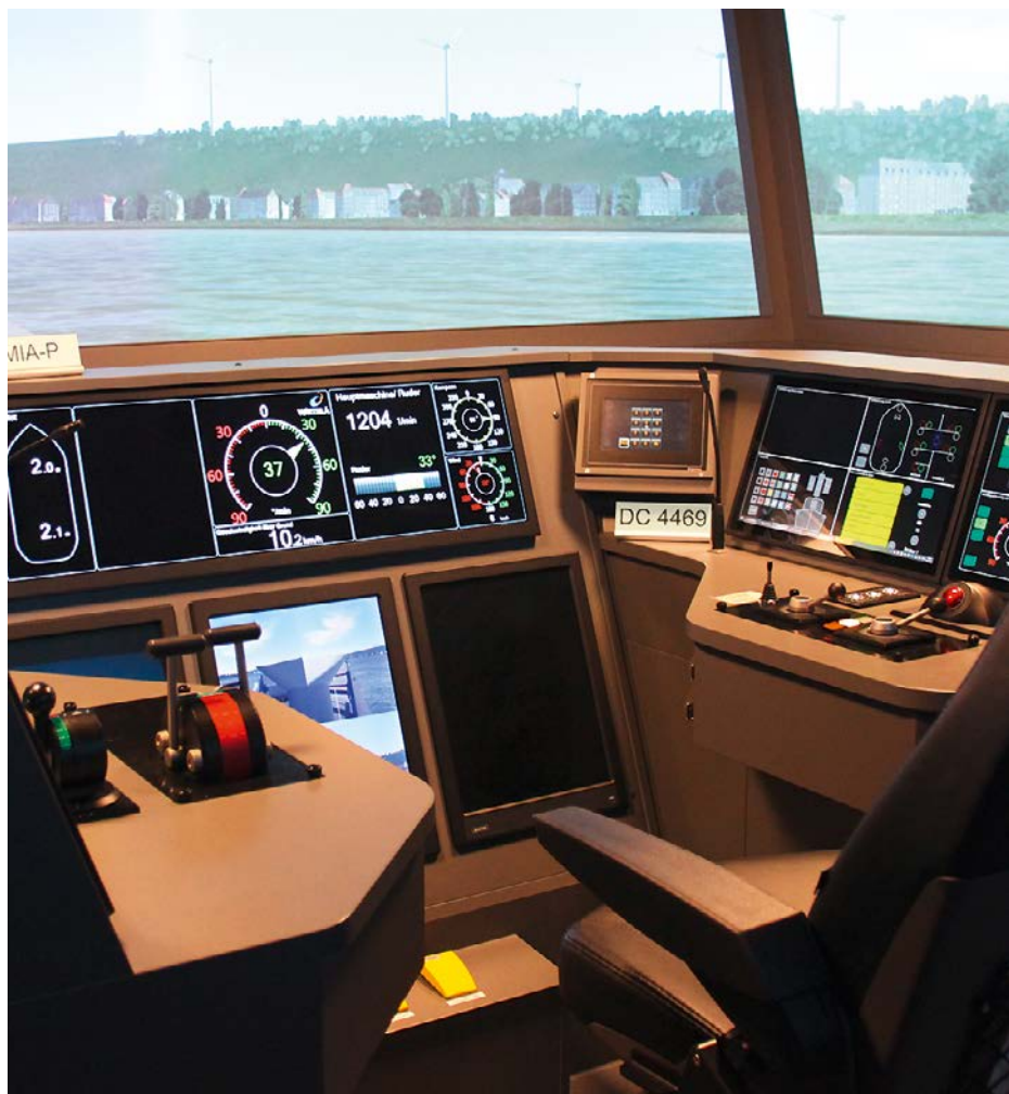
Einer der sieben Fahrstände des Flachwassersimulators Sandra II
