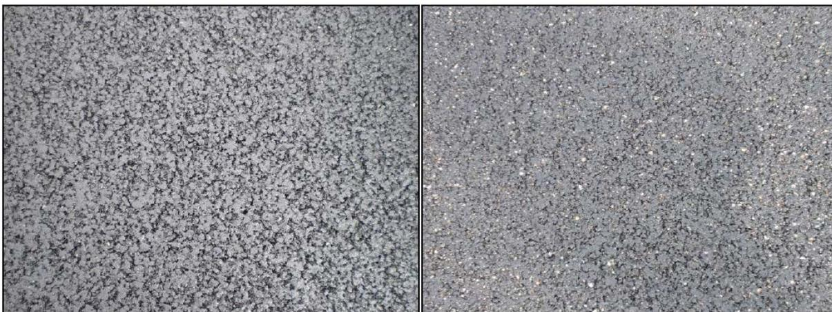
**Abbildung 4-68:** Oberfläche des SMA 8 Hmb. mit R8 nach Walzverdichtung.
