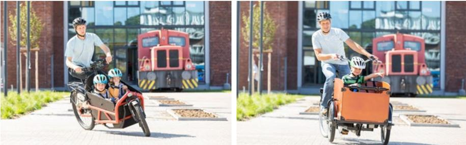
Mehrspurige Lastenfahrräder sind in der Regel standsicherer und müssen lediglich gegen ungewolltes Wegrollen gesichert werden. Einspurige Lastenräder sind im Stand und bei sehr geringen Geschwindigkeiten instabil und müssen entsprechend gestützt und ausbalanciert werden, um ein **Umkippen** zu vermeiden. Ein stabiler Fahrradständer mit breiter Abstützung ist zum Abstellen einspuriger Lastenfahrräder vorteilhaft.
