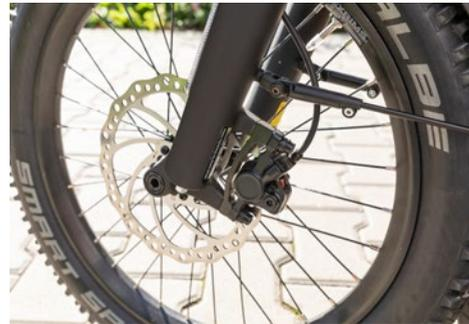
Während die Bremsen bei einem herkömmlichen Fahrrad üblicherweise auf das Fahrradgewicht und die aufsitzende Person ausgelegt sind, ist bei einem Lastenfahrrad auch die mögliche weitere Beladung zu berücksichtigen. Daher muss ein Lastenfahrrad 2 unabhängig voneinander wirkende Bremsen besitzen, welche auch auf das **maximal zulässige Gesamtgewicht** des Lastenfahrrades ausgelegt sind.
