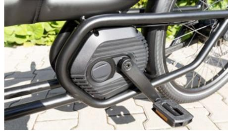
250 W und einer maximal unterstützten Fahrgeschwindigkeit von **25 km/h** sind solche Lastenfahräder mit Tretunterstützung sogenannte „Pedelects“ im Sinne des § 63a der Straßenverkehrs-Zulassungs-Ordnung (StVZO) und damit straßenverkehrsrechtlich im Hinblick auf Anforderungen den Fahrrädern gleichgestellt.
