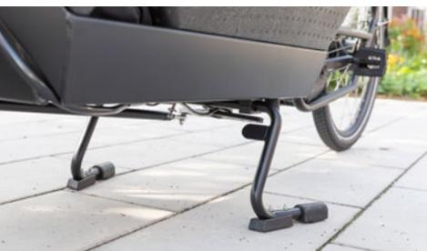
Neben den Bremsen zur Verzögerung des Lastenfahrrades ist es bei mehrspurigen Lastenfahrrädern zudem sinnvoll, eine **Feststellfunktion** (Feststellbremse oder Fahrradständer) gegen Wegrollen zu nutzen. Dies ist insbesondere bei der Sicherung mehrerer Kinder wichtig, damit das Lastenfahrrad während des An- oder Abschnallens nicht
