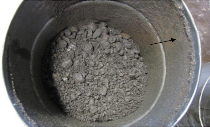
**Abbildung 6-3. Füllerverlust durch Anhaftungen an der Eimerwandung.**
