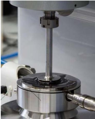
**Abbildung 3-19. Dynamisches Scherrheometer (DSR) mit Prüfgeometrie eines Platte-Platte-Mess-Systems mit einem Plattendurchmesser von 25 mm für den Temperaturbereich von +30 °C bis +90 °C.**
