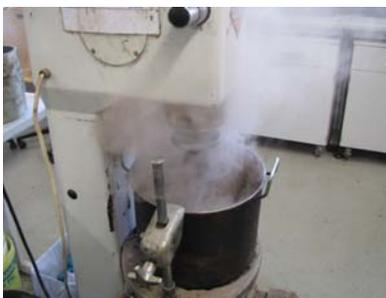
**Abbildung 6-2. Fülleraustrag während des Mischprozesses aufgrund von Wasserdampfentwicklung.**
