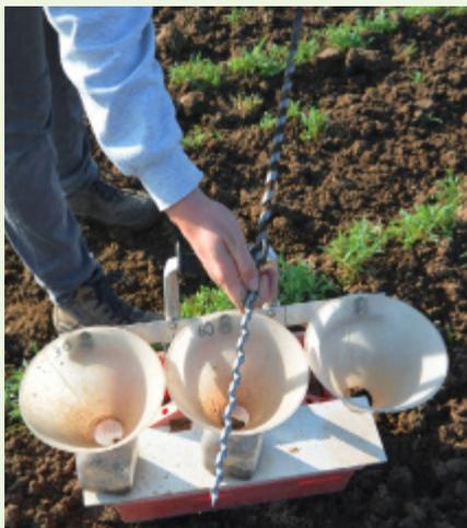
Abb. 15: Probenahme mit Spiralbohrer
