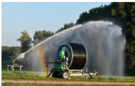
Abb. 54: Beregnungsmaschine mit Einzelregnerreinzug
