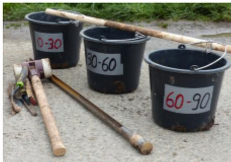
Abb. 12: Werkzeuge zur Probenahme
