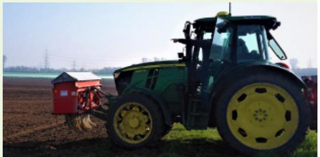
Abb. 22: Anbau des Kastendüngerstreuers vor dem Schlepper, kombinierbar mit Beetfräse oder anderen Geräten hinter dem Schlepper
