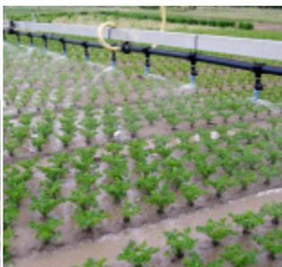
Beregnungsmaschine mit linearem Düsenbalken und zu hoher Niederschlagsdichte
