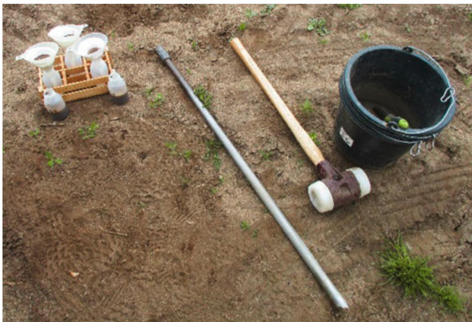
Abb. 17: Probenahme mit dem Bohrstock und Filtration für den Nitratschnelltest
