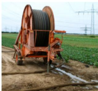
Beregnungsmaschine mit Einzelgroßregner und Undichtigkeiten an der Zuleitung
