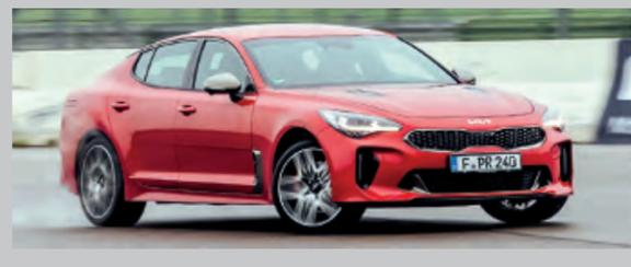
die Sportlimousine noch mal Vollgas: mit dem Sondermodell „Stinger Tribute Edition“, die auf der GT-Version mit Allradantrieb und 3,3 Liter V6-Twin-Turbobenziner (366 PS/269 kW) basiert. Der Stinger beschleunigt in 5,4 Sekunden auf Tempo 100 und ist 270 km/h schnell. Serienmäßig gibt es 19 Zoll-Leichtmetallfelgen und schwarze Brembo-Bremssattel mit rotem Schriftzug. **WMD**
