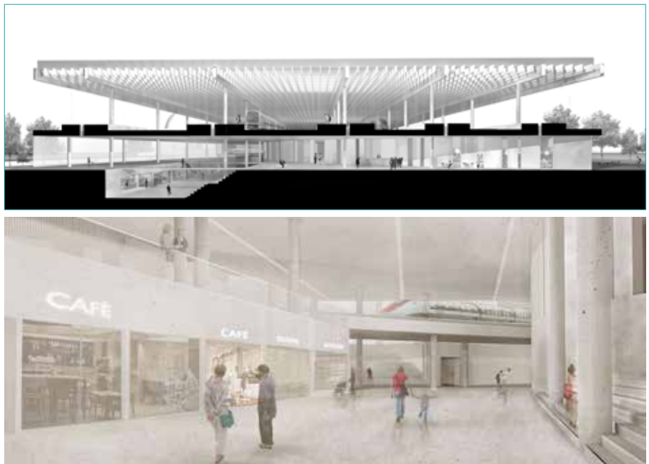
Abb. 2, 3: Erster Preis beim VDI-Wettbewerb – die Lage des Tiefbahnhofs bleibt erhalten, die Bahnsteige werden über eine neue Verteilerebene erschlossen.
