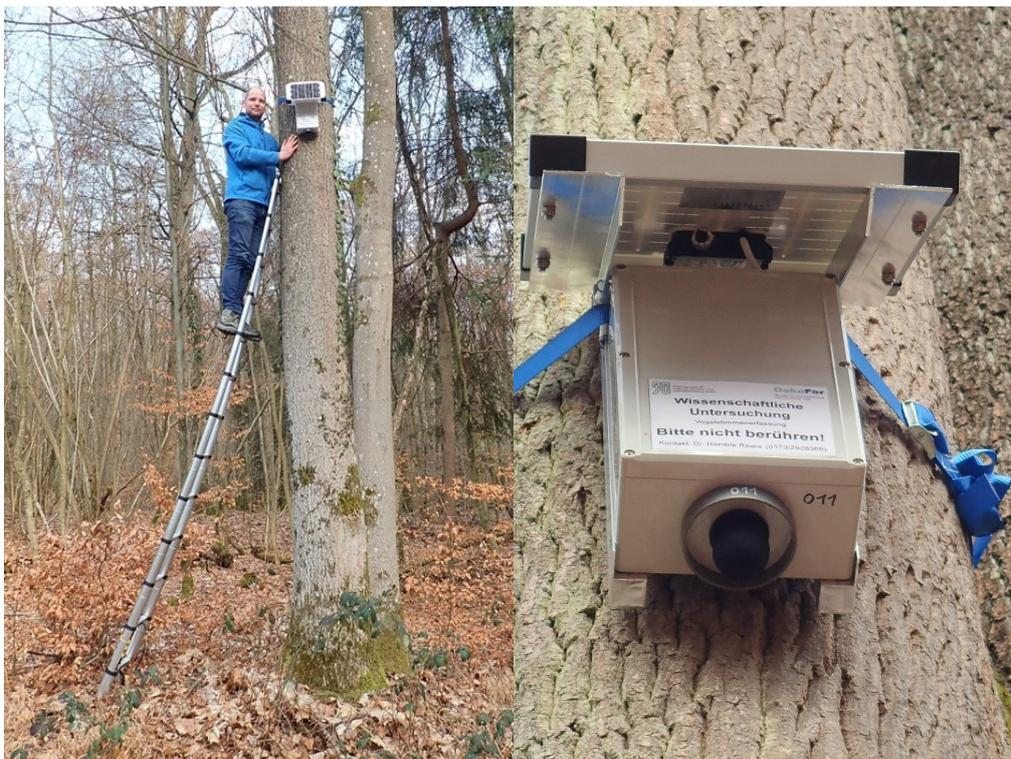
Abb. 1: Anbringen des Rekorders am Baum. Mittels einer Leiter konnten die Rekorder in der angestrebten Höhe von etwa 4 m angebracht werden. (Quelle: Arsu/OekoFor)
