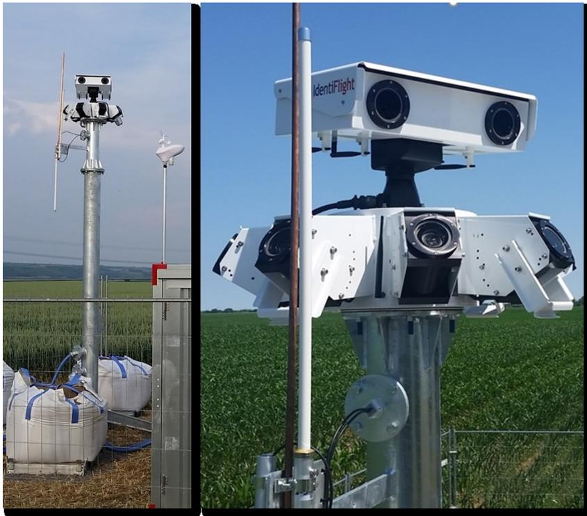
Abb. 57: Das System IdentiFlight, bestehend aus 8 Weitwinkelkameras und einer beweglichen Stereokamera.
