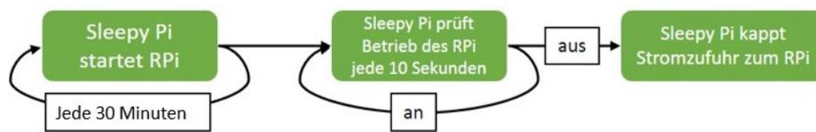
Abb. 3 Schematischer Ablauf der Sleepy Pi Programmierung (Quelle: Arsu/OekoFor)
