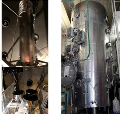
Abb. 22: Versuchsanlage REKO-4 (rechts); verschiedene Rekombinatoren (links)
