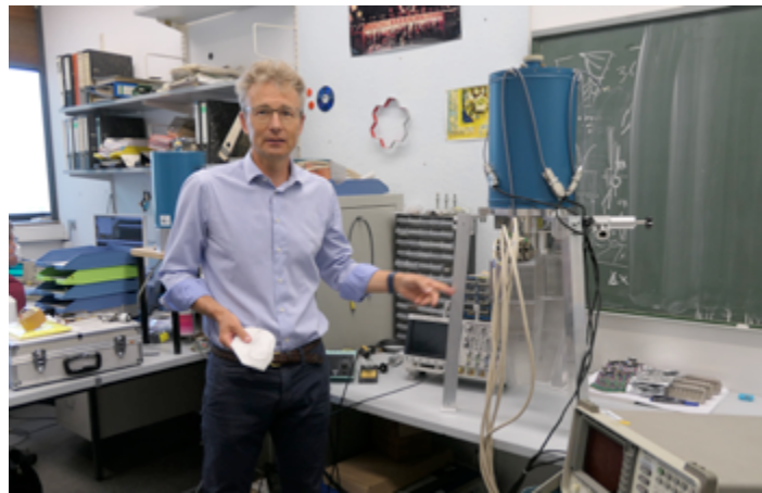
Prof. Reiter in einem Labor, in dem High Purity Germaniumdetektor (HPGe) getestet werden. Im blauen Dewar befindet sich flüssiger Stickstoff, der fast minus 200 Grad Celsius kalt ist, und somit das HPGe Material, unterhalb in der Aluminium Kammer zu erkennen, auf entsprechende Temperaturen abkühlt. Um den Detektor und Teile der Messelektronik kühlen zu können, muss die Detektor-kammer luftleer sein, dafür braucht eine Hochvakuumpumpe zwei bis drei Tage. Die neue BMBF Förderung ermöglicht u.a. die Entwicklung und den Bau neuer HPGe Detektoren für das AGATA- und das MINIBALL Spektrometer am IKP.
