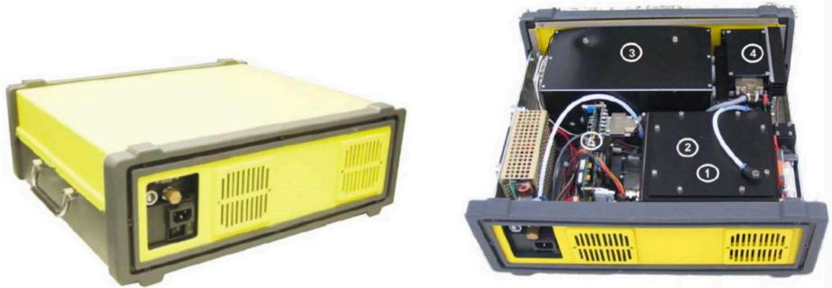
**Abbildung 14** Aufbau und Komponenten des FT-IR-Gas-Analysators GASMET™ DX4000N von Asynco.
