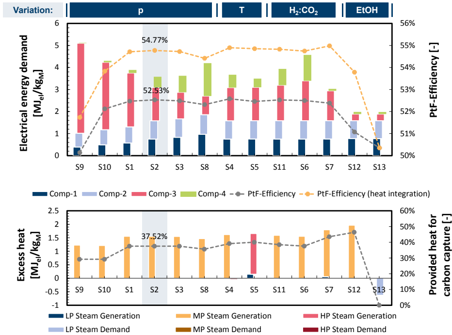
Abb. 4.5.: Simulationsergebnisse der Prozessanalyse zur CO 2 -basierten Methanolsynthese in Aspen Plus
