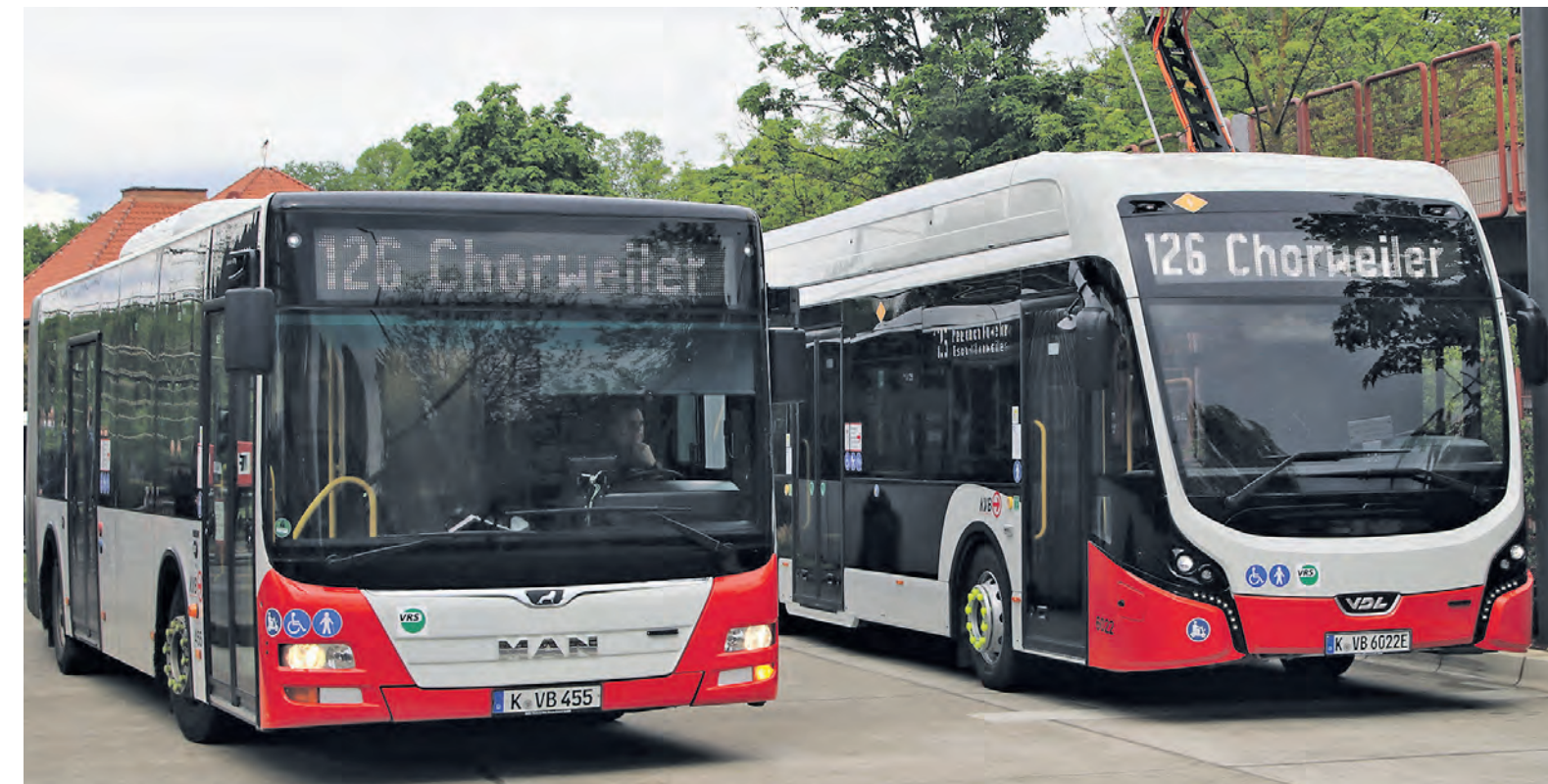
Busse der neuesten Generation mit Elektroantrieb (r.) ersetzen nach und nach die Diesel-Fahrzeuge
