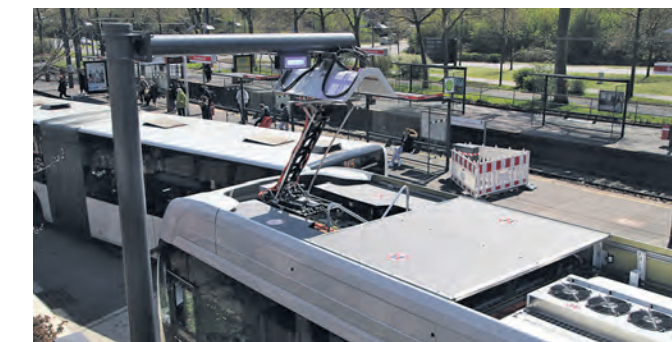
Über sogenannte Pantografen werden die Batterien „betankt“
