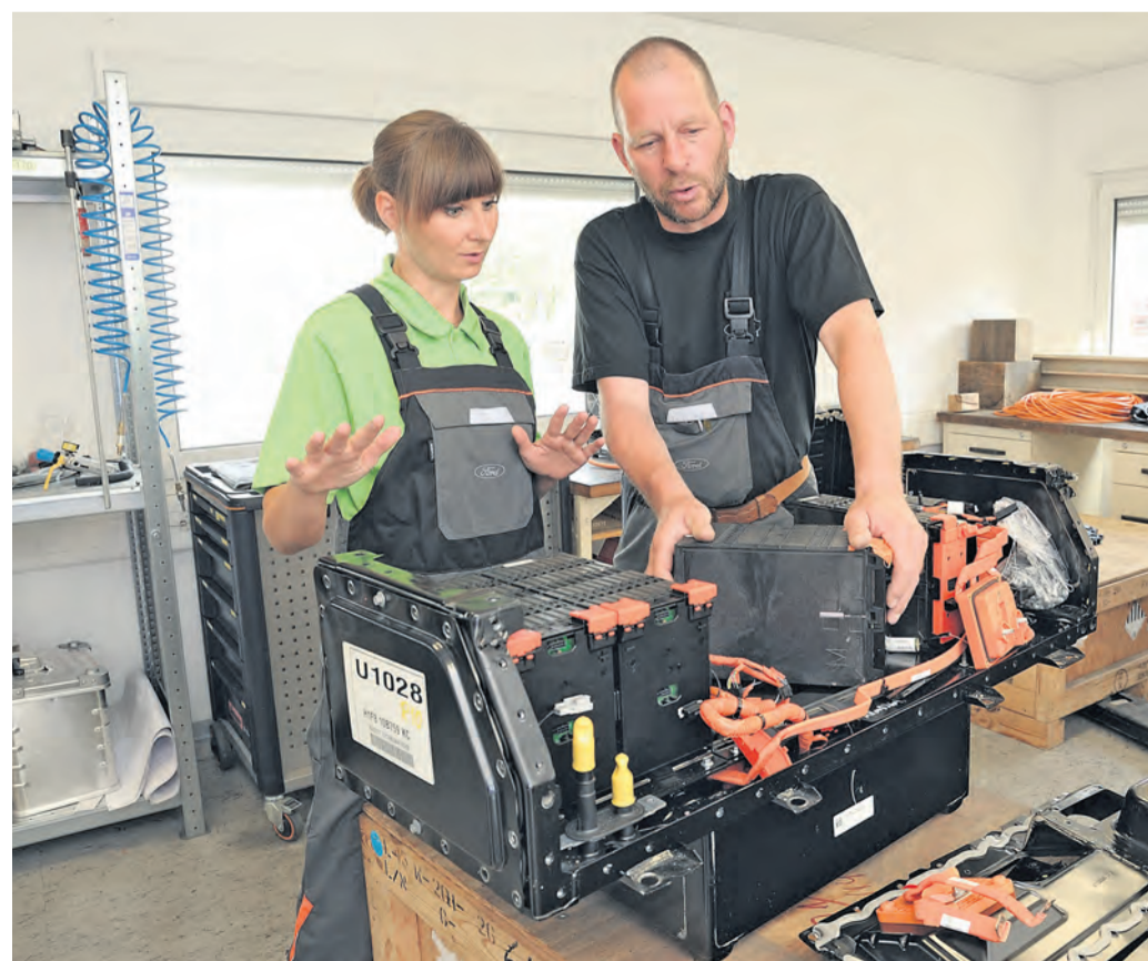
Fachleute fertigen die Batteriestacks
