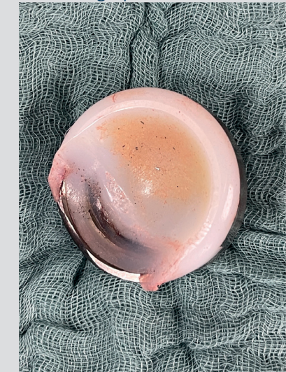
Explantat Glenoid mit deutlichen Abnutzungsspuren
