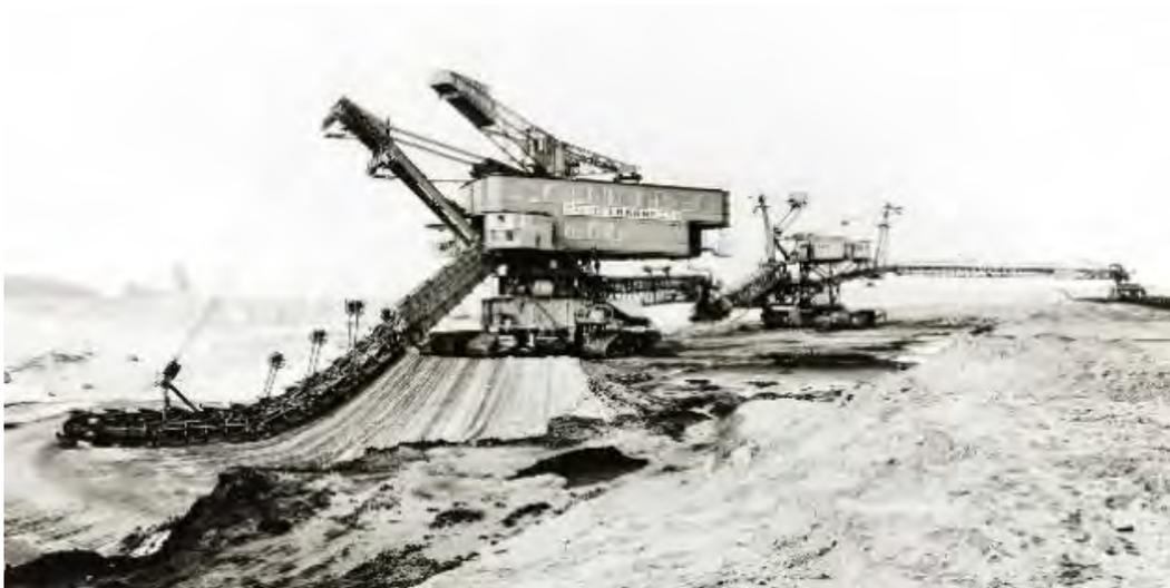
Gewinnungsgeräte im Förderbrückentagebau. Schaufelradbagger (oben) werden meist bei der Kohlegewinnung eingesetzt, Eimerkettenbagger (unten) im Abraum.
