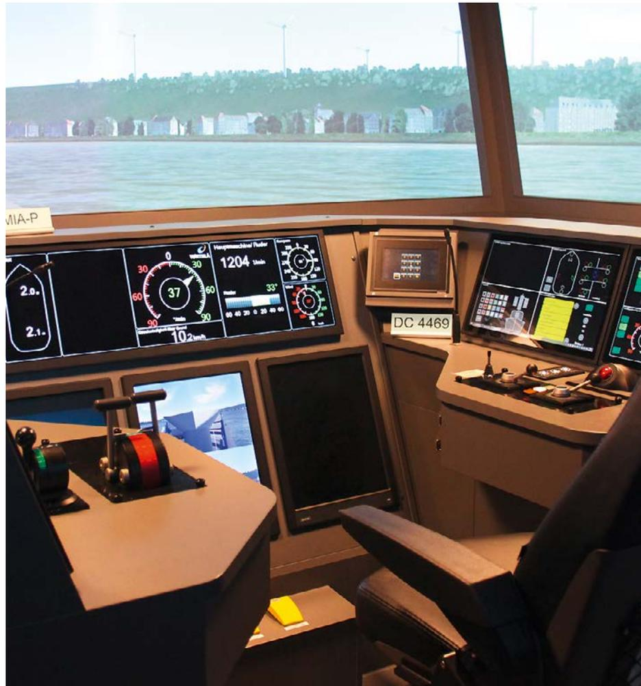
Einer der sieben Fahrstände des Flachwassersimulators Sandra II
