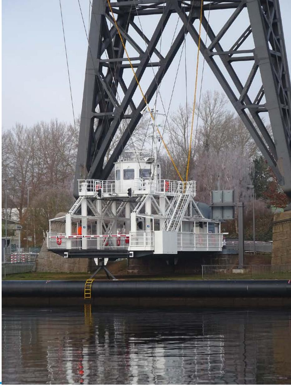
Der Steuerstand der neuen Schwebefähre wurde nicht nur auf dem Papier geplant: Die Prüfung eines Eins-zu-eins-Holzmodells oblag unter anderem Fachleuten für Arbeitssicherheit und den Fährmaschinistinnen und Fährmaschinisten. Anschließend konnten gewünschte Anpassungen vorgenommen werden.
