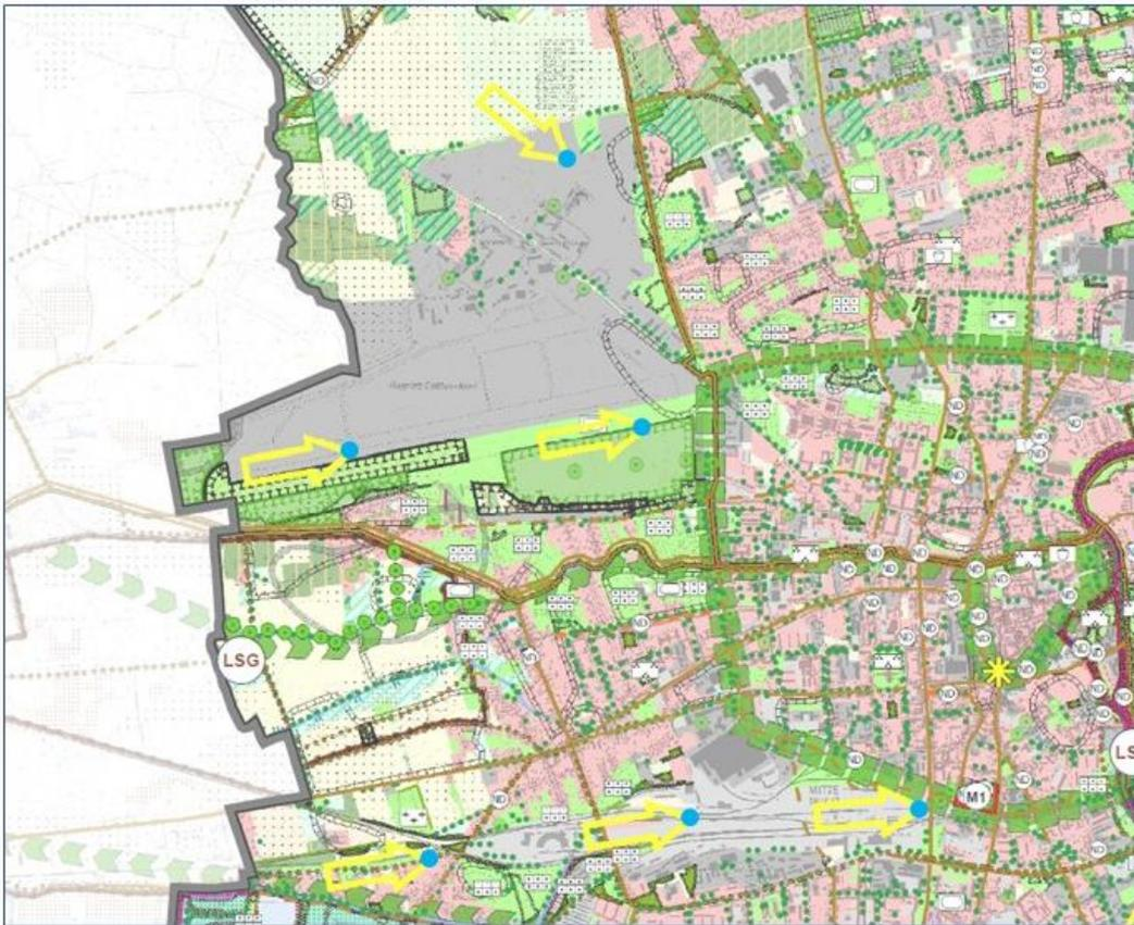
Abb. 25: Ein Beispiel für den Unterschied zwischen Kartenpräsentation und Geodaten : Frischluftschneisen werden in der Karte von gelben Pfeilen repräsentiert, die zugehörigen Geodaten sind Punktobjekte (hier blau dargestellt), denen eine Gradangabe für die Drehung des Pfeils als Attribut beigefügt wurde (LP Cottbus 2016)
