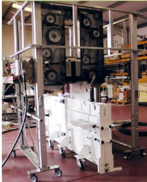
**Abb. 4.6** Ferngesteuertes Equipment zur Rohrtrennung und eine Diamantseilsäge, die für Stilllegungsarbeiten in der FGFL eine Genehmigung erhalten haben /ONR 21/
