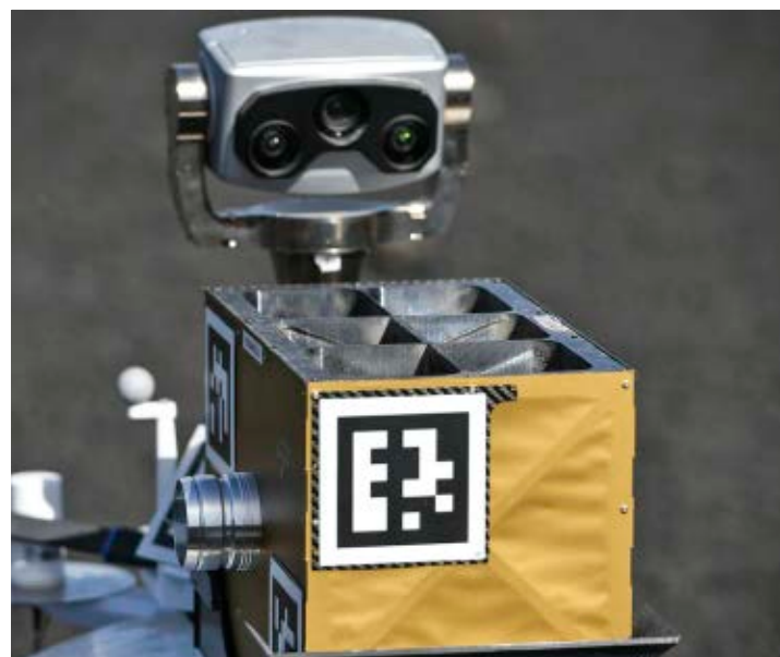
Die schwarz-weißen Markierungen sind wie Namensschilder. Die Roboter erkennen sich gegenseitig und identifizieren ihre Ladung. LRU2 trägt hier eine Box für Gesteinsproben.
