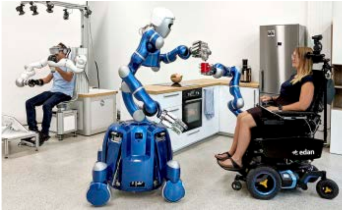
Im Projekt werden mehrere Systeme erprobt (von links): eine haptische Eingabestation mit zwei Leichtbauarmen (HUG), der humanoide, zweiarmlige mobile Heim-Assistenzroboter Rollin' Justin sowie EDAN, ein Rollstuhl mit einem Leichtbau-Roboterarm und einer Hand.
