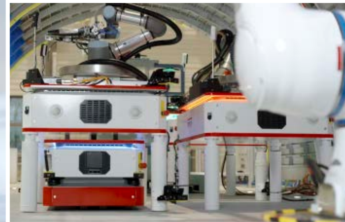
Die mobilen Transporteinheiten bringen die Roboter an ihren Einsatzort. Sie sind mit Sensoren ausgestattet, die Bewegungen registrieren. Sollte ihnen ein Mensch zu nahe kommen, stoppen sie so lange, bis der Weg wieder frei ist.
