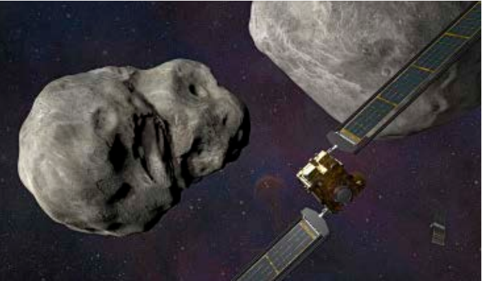
Die Raumsonde DART kollidierte in 11,6 Millionen Kilometer Entfernung zur Erde mit einem Asteroiden und lenkte ihn von seiner Bahn ab.
