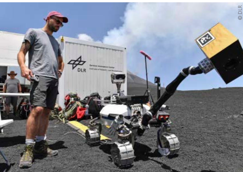
Der Assistent LRU2 benutzt seinen Arm, um Analysen durchzuführen oder Payload-Boxen zu handhaben.
