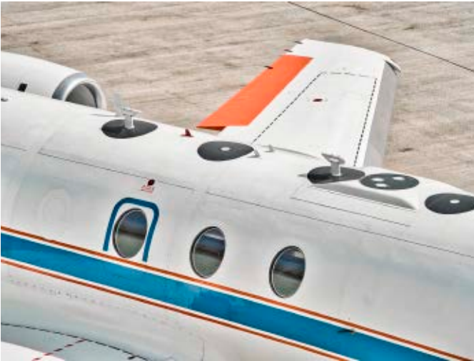
Auf dem Rücken des DLR-Forschungsflugzeugs Falcon befinden sich die Sensoren für die Laserabsorptions-Spektroskopie. Sie untersuchen, wie stark die Sauerstoffmoleküle in der Atmosphäre den Laserstrahl zwischen den Sensoren absorbieren.
