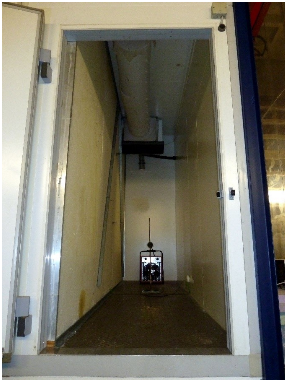
Abbildung 3.6: Luftkonditionierung mit Kältemaschine und Heizlüfter in der Klimakammer
