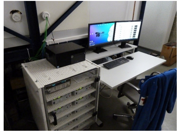
Abbildung 3.13: Leit-PC mit Labornetzgeräten
