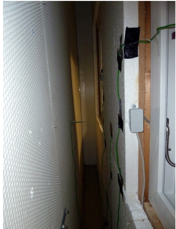
Abbildung 3.7: Strömungs-Gleichrichter und Fensterbereich in der Klimakammer
