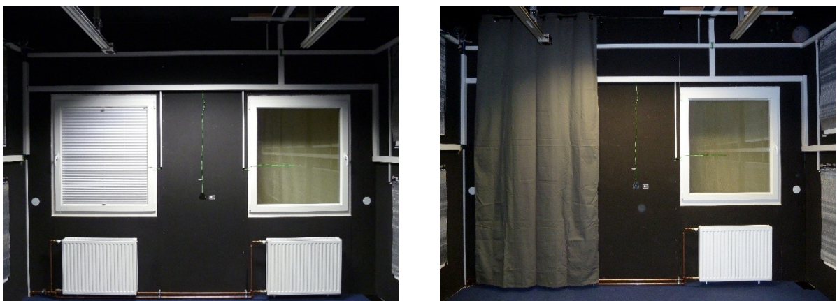
Abbildung B.1: Versuchsaufbau zur Betrachtung von innenliegendem Sonnenschutz (links: Plissee, rechts: Gardinenschal)
