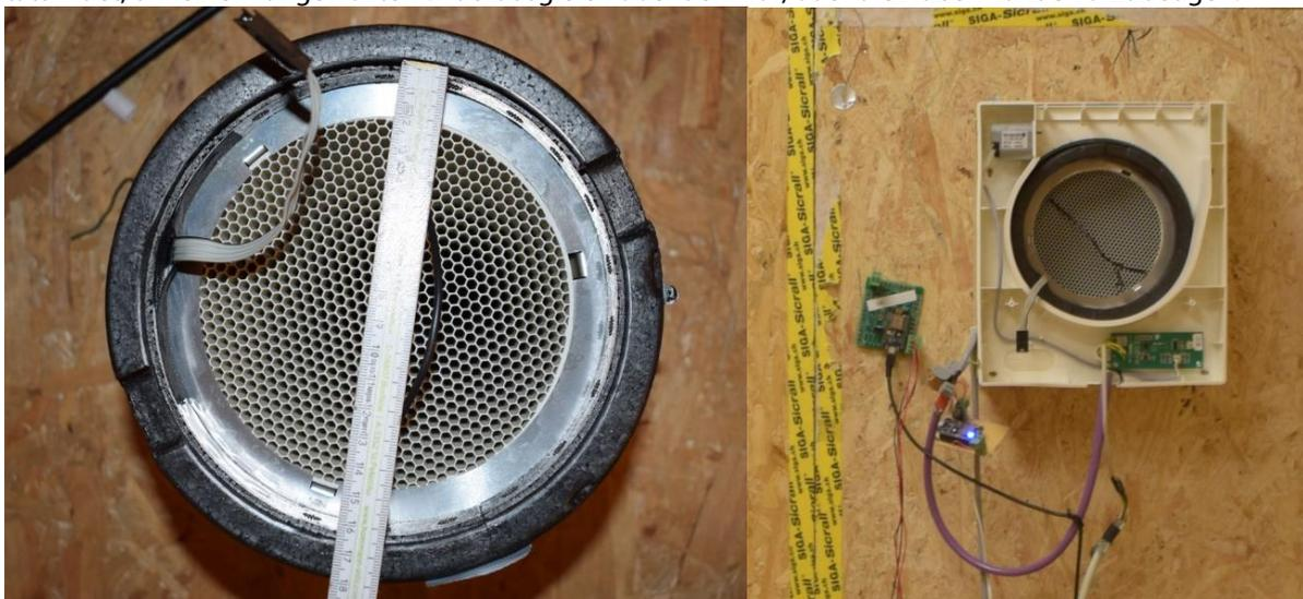
Abbildung 21 li. Pendellüfter mit wabenförmigem Wärmespeicher, ohne Abdeckung; re.: Pendellüfter mit Ansteuerungselektronik
