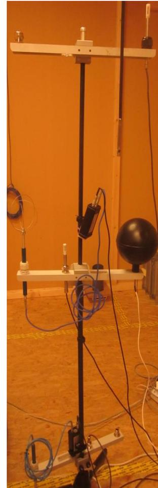
Abbildung 2 Für die Behaglichkeitsmessung verwendeter Messbaum mit Sensoren auf 0,1 m, 1,1 m und 1,7 m
