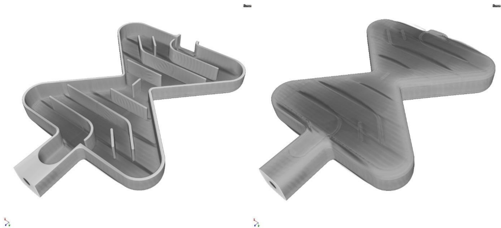
Abbildung 7.9: 3D Computertomographie-Aufnahmen des BF1-Moderators, links ist der Horizontalschnitt und rechts das gesamte Bauteil dargestellt
