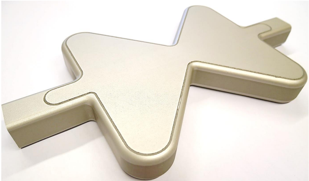
Abbildung 7.11: Gefertigter und geprüfter BF1-Moderator Prototyp
