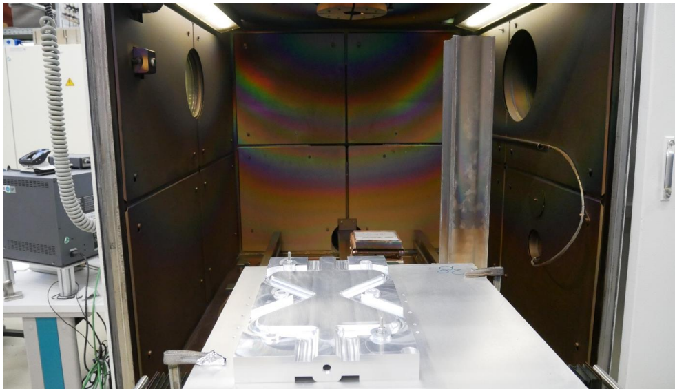
Abbildung 7.3: Elektronenstrahlschweißen des BF1-Moderator Prototyps
