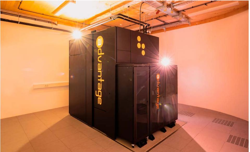
**Der D-Wave Quantenannealer an seinem neuen Standort im vibrationsfreien JUNIQ-Gebäude**
