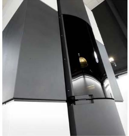
Das Elektronenmikroskop PICO kann Atomabstände und -verschiebungen auf einen Pikometer genau messen.
