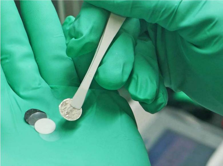
**Noch im Laborstadium: Komponenten der Lithium-Festkörper-Batterie mit Hybridelektrolyt**
