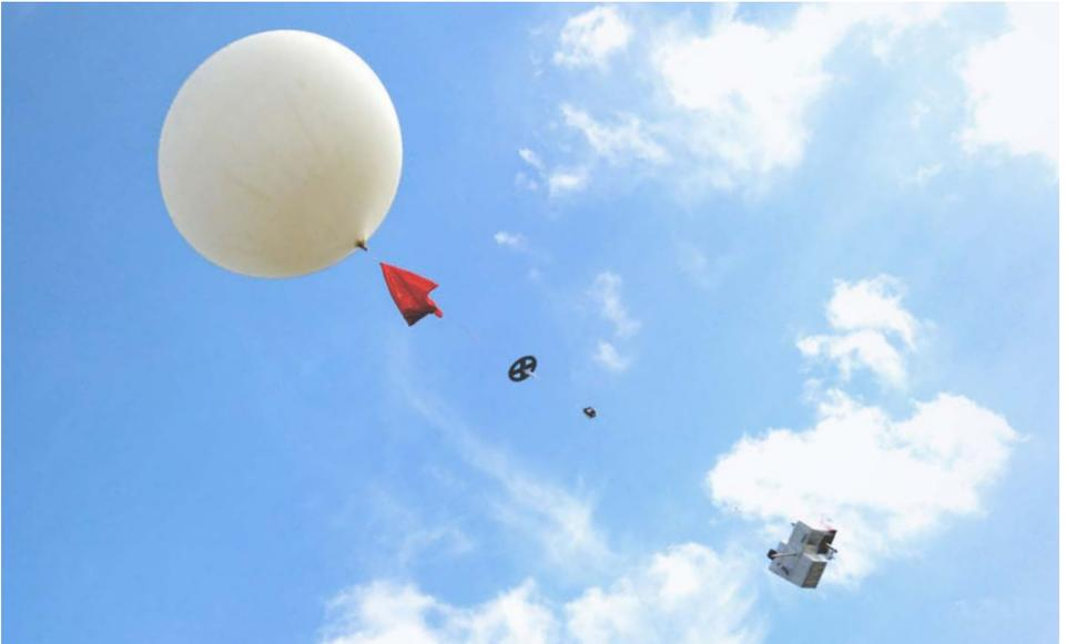
**Bei einer Messkampagne auf der Zugspitze wurde mit vier Ballonaufstiegen die Verteilung von Wasserdampf und Eiswolken in der Atmosphäre gemessen.**
