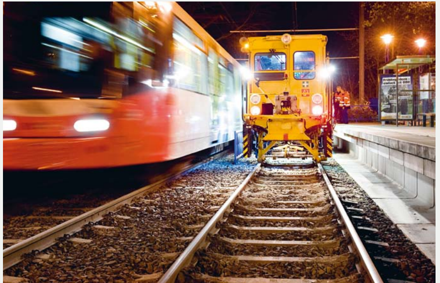
ZURECHTGERÜTTELT : Die Gleisstopmaschine fährt das Gleisbett ab. Sie rüttelt das Schotterbett gezielt durch, damit der Schotter wieder dichter und damit stabiler wird.
