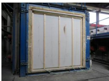
Abbildung 33: Kleinbrandversuch (1-m) Wand und Decke nach dem E-Versagen
