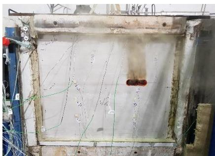
Abbildung 69: Gipskasten nach dem Versuch mit Bekleidung (V4a)
