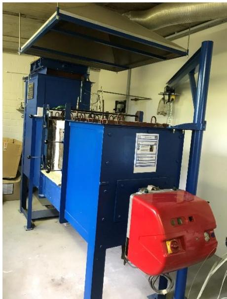
Abbildung 40: Prüfkörper 1 nach dem Einbau in den Brandprüfofen (Goth 2021)
