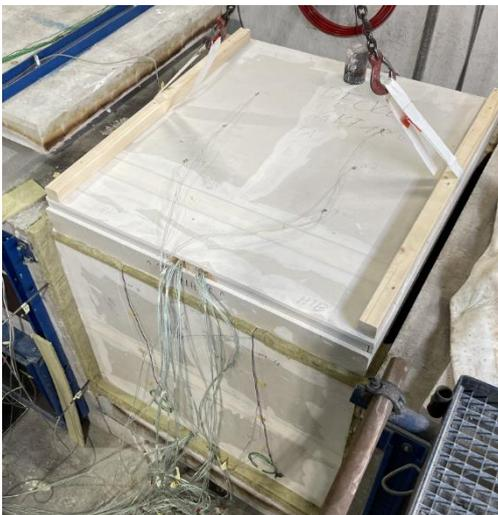
Abbildung 51: Prüfung der BSP-Elemente im 1-m-Ofen
