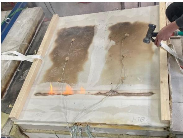
Abbildung 59: Wandkonstruktion nach der Prüfung in V2-W-1m-HTB-18 mm GKF und im Gefach vorhandener Dämmung
