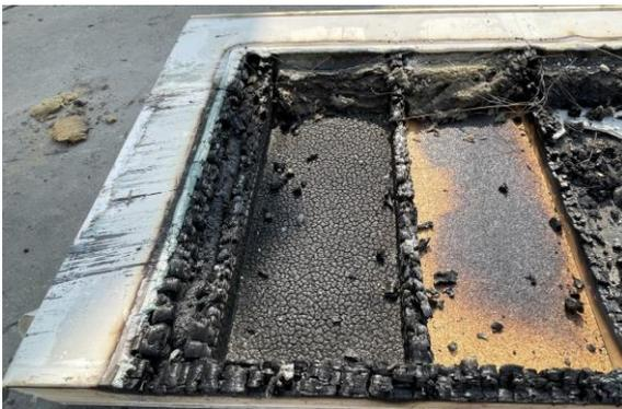
Abbildung 55: Referenzdecke BSP nach dem Brandversuch mit Holzkohleschicht und teilweise abgelöster erster Brettlage.
