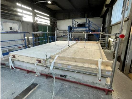
Abbildung 45: Ansicht feuerzugewandt / aus dem inneren des Brandofens: Holztafelbau / Brettsperrholz, bekleidet mit 18 mm GKF
