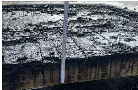
Abbildung 56: Versagen der Gipsplatte in der 46. Prüfminute in V2-D-1m-HTB-18 mm GKF
