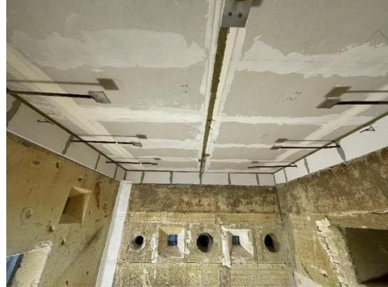
Abbildung 46, Abbildung 47 und Abbildung 48 zeigen beispielhaft die Aufbauten für die ergänzenden Prüfungen der Holztafelbauwände / -decken sowie der Brettsperrholzwände / -decken im 1-m-Ofen. Eine detaillierte Darstellung der Versuchsaufbauten kann Anlage A 11 bis A 15 entnommen werden.
