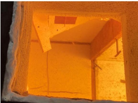
Abbildung 57: Versagen der Gipsplatte in der 77.-79. Prüfminute in V2-W-1m-HTB-18 mm GKF
