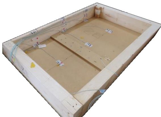
Abbildung 76: Brandversuch – 15 mm MDF-Platte am Wandbauteil nach 19 min Brandbeanspruchung
