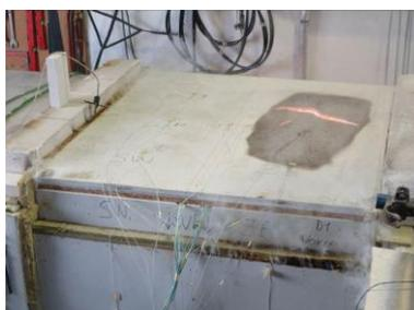
Abbildung 34: Teil-8 Versuch (ca. 50 cm x 50 cm) ZF nach dem I und kurz vor dem E-Versagen
