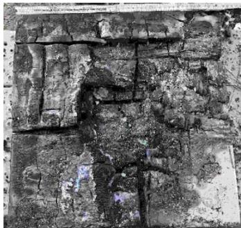
Abbildung 71: Gipskasten nach dem Versuch mit demontierter Bekleidung (V4b)
