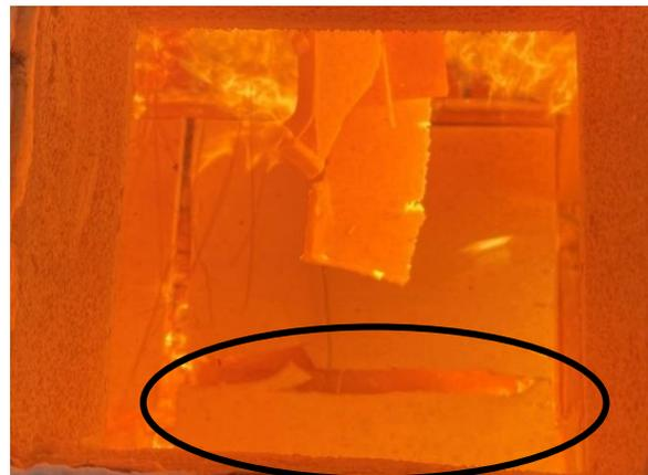
Abbildung 58: Versagen der Decke in der 93. Prüfminute in V2-D-1m-HTB-18 mm GKF (Durchbrand in der Stoßfuge)
